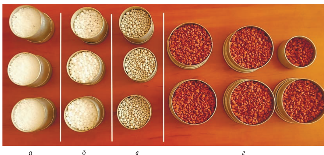
Рисунок 4 – Лабораторные кюветы с пробами минеральных удобрений для исследования гранулометрического состава: а – карбамид; б – селитра аммиачная; в – суперфосфат двойной; г – хлористый калий
