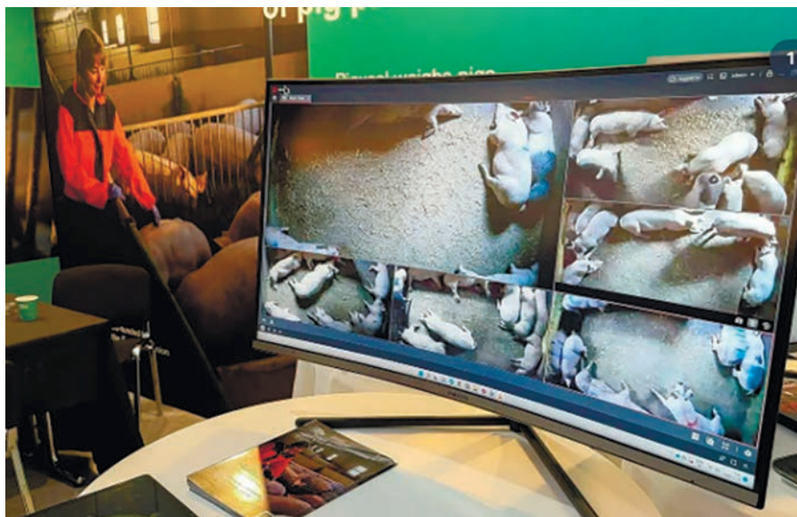
Рисунок 4 – Программно-аппаратный комплекс для автоматического взвешивания свиней Pigxcel
