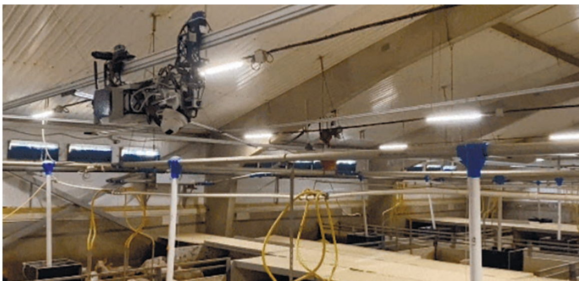
Рисунок 3 – Видеоаналитический сервис с роботизированной кареткой для перемещения видеокамеры
