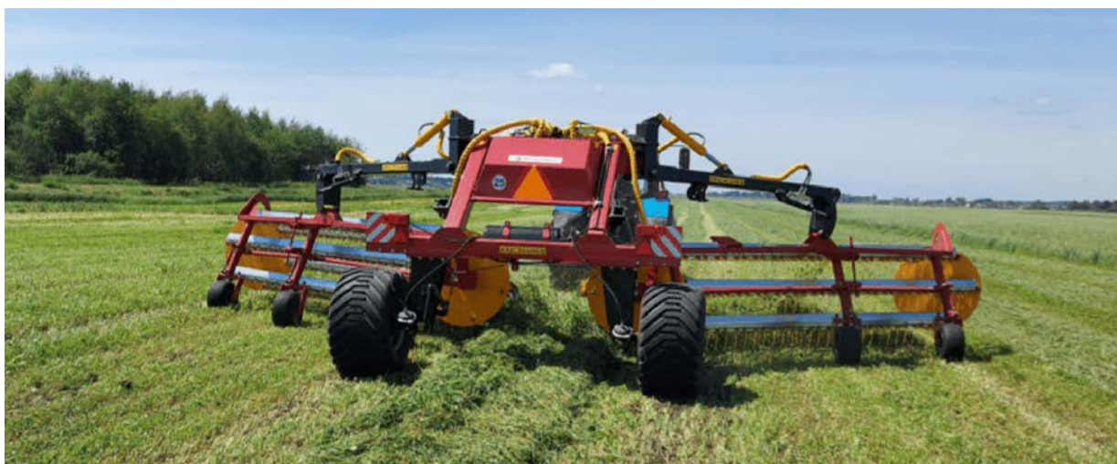
Рисунок 4 – Опытный образец граблей-валкователей гребенчатых ГВГ-9,5
