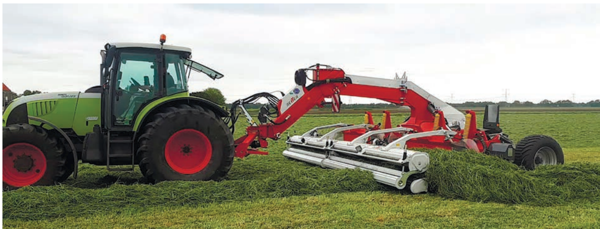
Рисунок 3 – Ленточный валкователь Respiro R9 profi в работе
