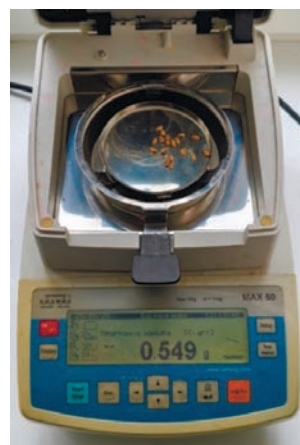
Рисунок 6 – Приборы: а – тахометр электронный UT 370; б – электронные весы ВЭУ-6-1/2 (ТУ 25–7724–010–98); в – электронный микроскоп Andostar AD209; г – электронные весы MAX 50 Radwag
