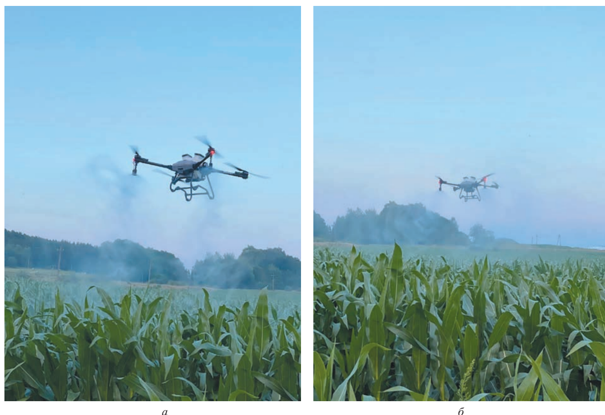
Рисунок 4 – Предварительные испытания агродрона с различными параметрами полета при обработке кукурузы в стадии «9–10 листьев»: а – завихрения распыляемого раствора при высокой скорости полета; б – снос рабочего раствора при мелкодисперсной капле
