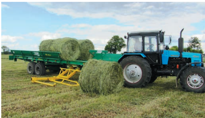
Рисунок 2 – погрузчик-транспортёрщик рулонов типа ТП-10
