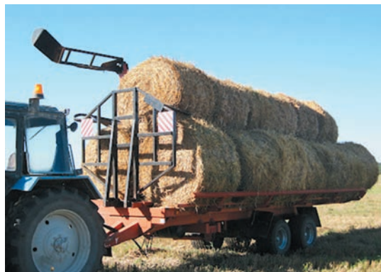
Рисунок 3 – погрузчик-транспортёрщик рулонов ПТР-12С
