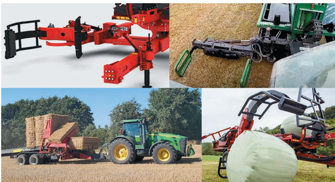
Рисунок 6 – Зарубежные специализированные сборочно-транспортные средства с автоматизированным подбором и загрузкой спрессованных кормов
