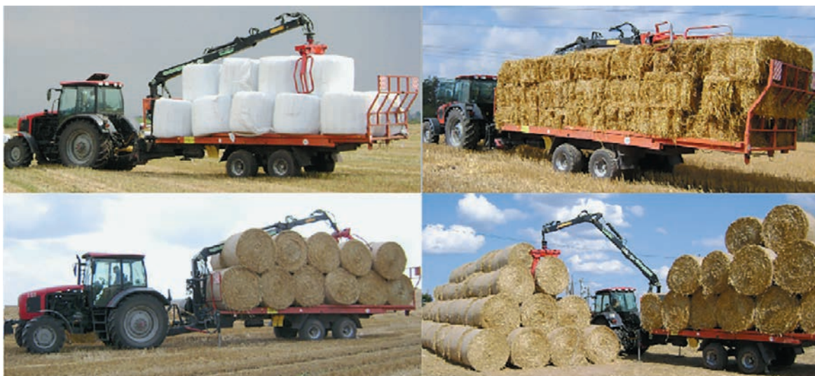
Рисунок 5 – Самозагружающаяся платформа с манипулятором ПМК-10
