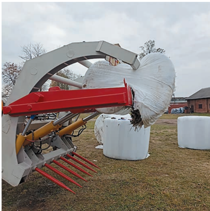
Рисунок 5 – Испытание макетного образца – разрезание рулона неизмельченного сенажа
