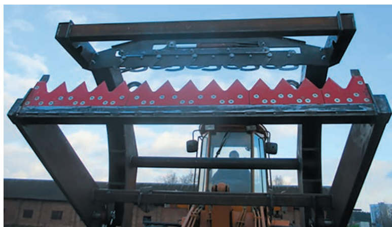
Рисунок 3 – Вид на захват крючковый УСП 03.00.000 и резак УСП 02.00.000
