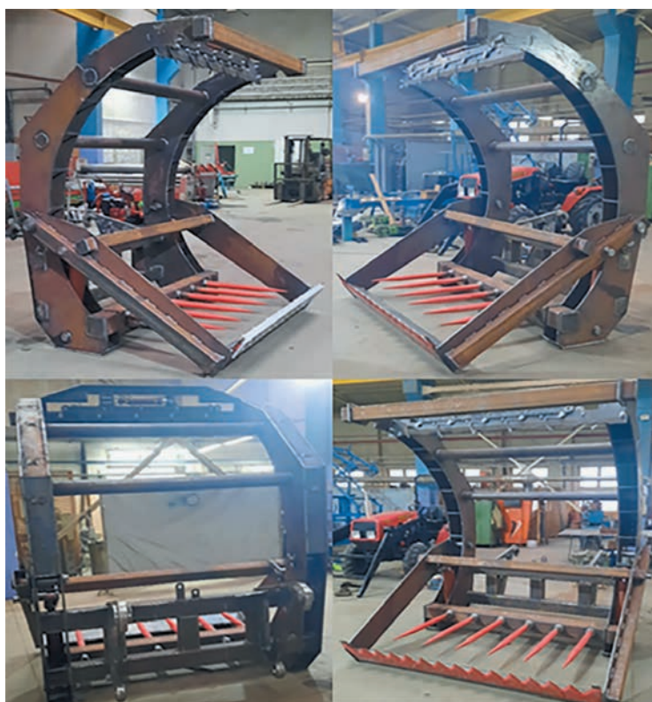
Рисунок 1 – Макетный образец устройства для снятия полимерных материалов с запрессованных кормов
