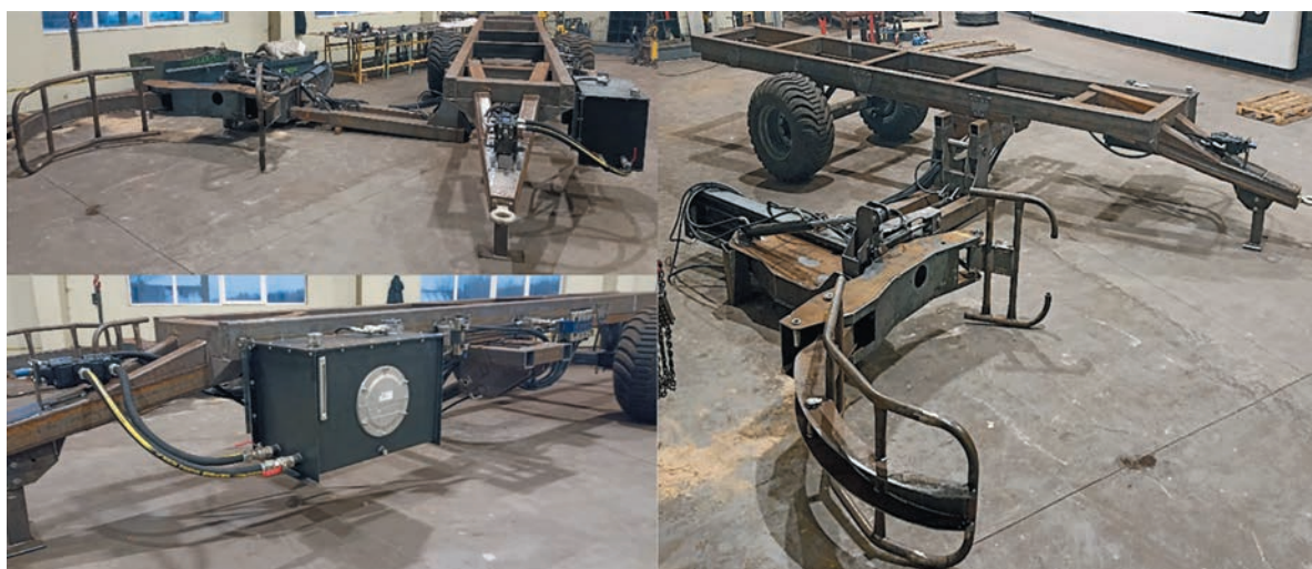
Рисунок 2 – Общий вид макетного образца захватывающего устройства для автоматизированного подбора и загрузки спрессованных кормов на транспортную платформу
