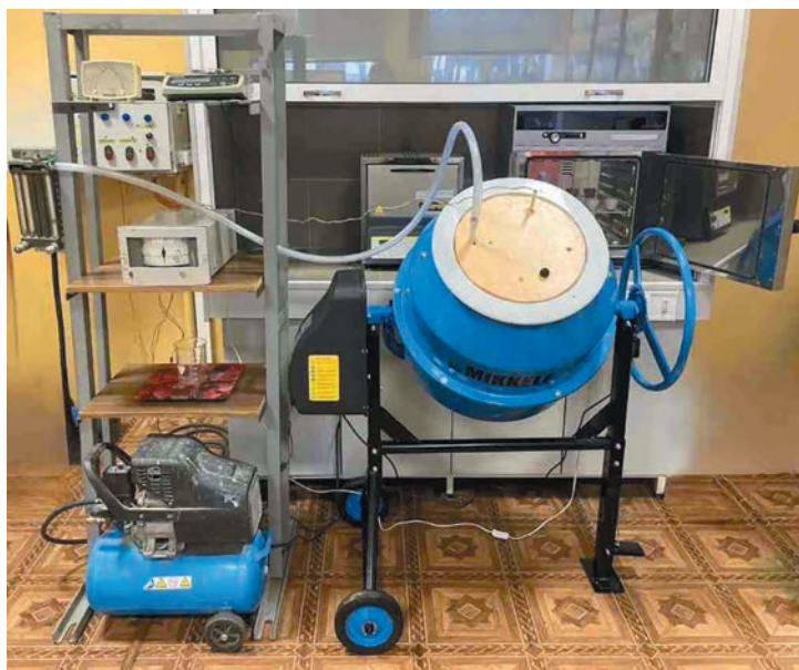
Рисунок 2 – Общий вид экспериментальной установки для исследования режимов самосогревания в аэробных условиях твердых сепарированных отходов на их тепловлажностные характеристики
