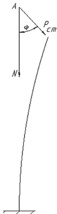
Рисунок 3 – Действие силы, проходящей через фиксированную точку A
