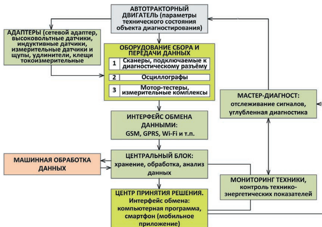
Рисунок 6 – Структурированная схема интеллектуальной системы диагностирования автотракторных двигателей
