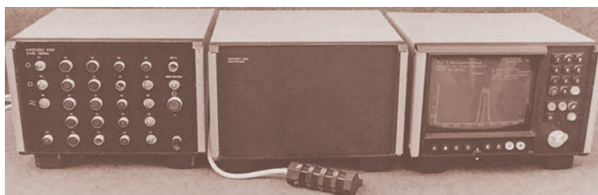
Рисунок 3 – Внешний вид комплекса К-539 СКБ Киевского ПО «Точэлектроприбор» (слева направо): блок связи К-539/БС, контроллер К-539/КТ и терминал К-539/ТМ
