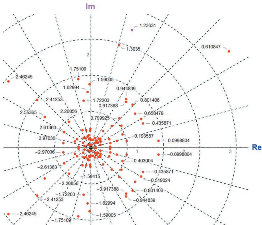
Рисунок 3 – Графическая интерпретация преобразования Фурье в комплексной плоскости для сигнала виброускорения топливной форсунки на стенде с дробящим распылением топлива с указанием вычисленных фаз колебаний для каждой гармоники спектра
