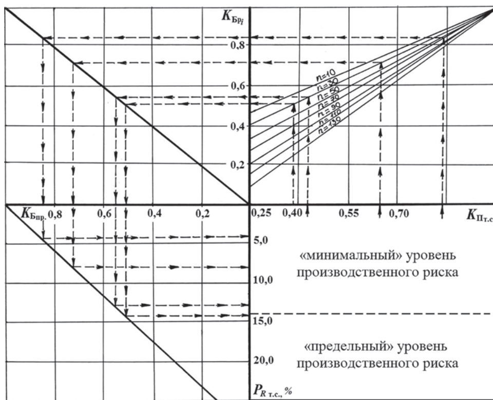
Рисунок 2 – Номограмма для оценки производственного риска с учетом интенсивности выполнения технологических регулировок при эксплуатации МСХТ
