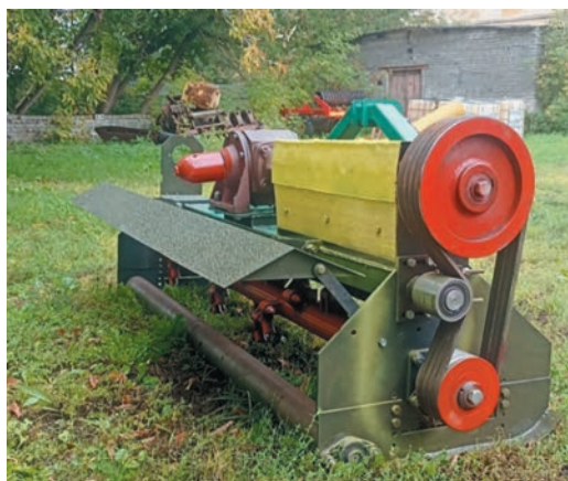
Рисунок 2 – Общий вид измельчителя растительных остатков лубяных культур
