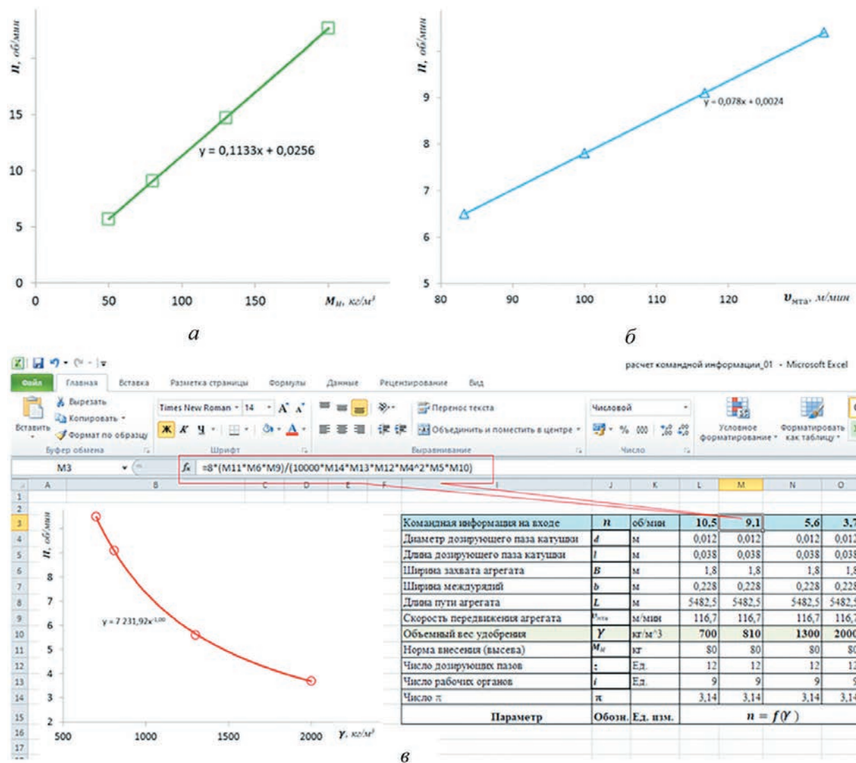
Рисунок 3 – Результаты компьютерных экспериментов: а – изменение нормы внесения удобрений; б – изменение скорости прямолинейного движения агрегата; в – изменение удельного веса
