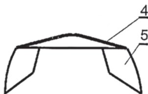
Рисунок 2 – Схема формователя-уплотнителя (вид спереди): 4 – козырек; 5 – корпус
