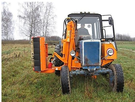
Рисунок 98 – Экспериментальный образец косилки-измельчителя КИО-1 при проведении исследовательских испытаний
