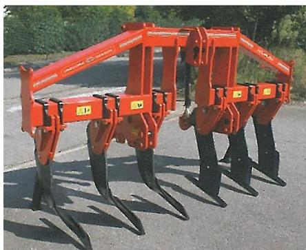
*Рисунок 24 – Глубокорыхлитель фирмы «Gregoire-Besson» (Франция)*
