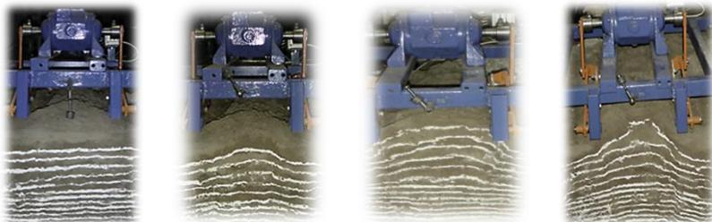
*а) слои ровные; б) за 7 см до подкапывающих лап; в) за 2 см до подкапывающих лап; з) подкапывающие лапы видны*
