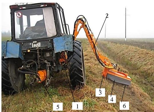
**Рисунок 97 – Общий вид экспериментального образца косилки-измельчителя для откосов каналов КИО-1**
