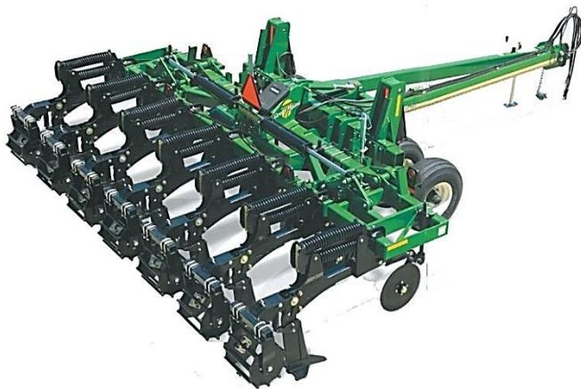
*Рисунок 25 – Глубокорыхлители моделей SS фирмы «Great Plains» (США)*
