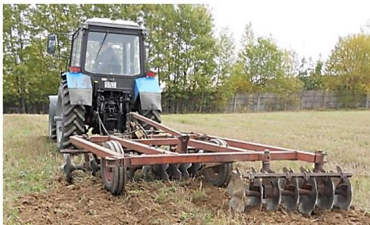
*Рисунок 56 – Экспериментальная дисковая борона*
