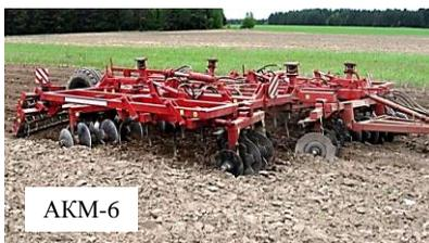
*Рисунок 40 – Агрегаты комбинированные для минимальной обработки почв*
