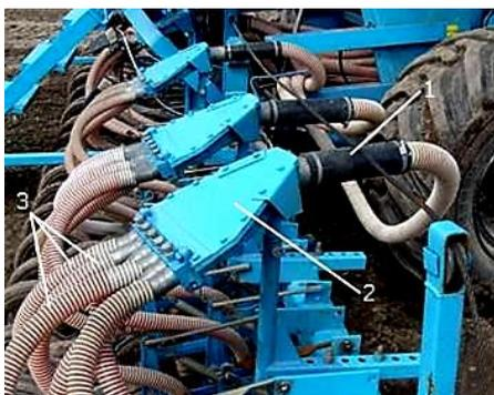
1 – выравнивающее устройство; 2 – распределитель посевного материала; 3 – семяпроводы
