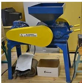
**Рисунок 40 – Общий вид вальцового измельчителя-плющилки зерна ИПЗ-3**
