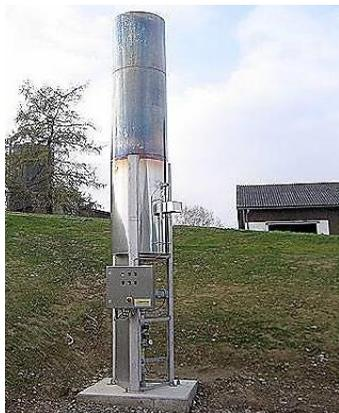
Рисунок 83 – Общий вид автоматизированного факельного устройства
