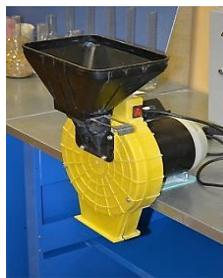
**Рисунок 41 – Общий вид молотковой дробилки ИК-1**
