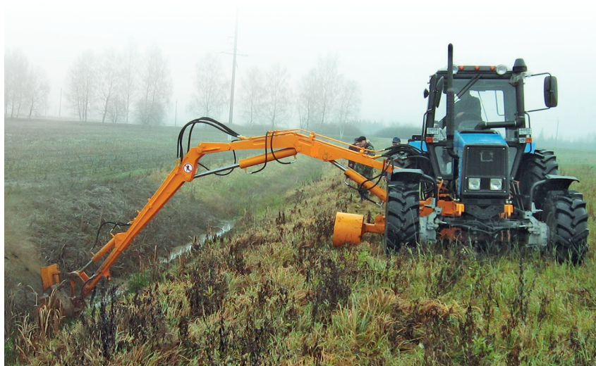
Рисунок 2. – Каналоочиститель с ротационным рабочим органом КОРО-2 в рабочем положении
