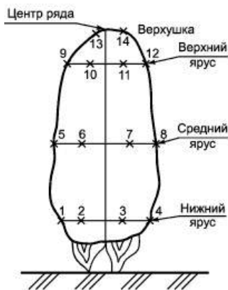
Рисунок 9. – Схема размещения карточек на моделях кустов
