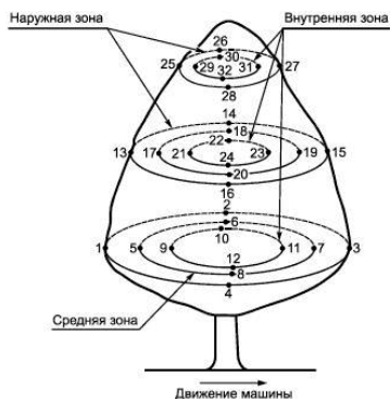
Рисунок 8. – Схема размещения карточек на макетах деревьев
