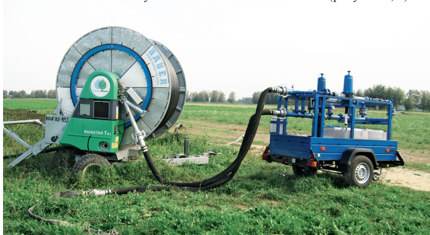
Рисунок 2. – Общий вид оборудования для гидроподкормки ОГД-50 с дождевальной установкой Rainstar T 61 при проведении испытаний
