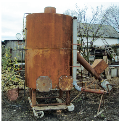
Рисунок 3. – Ферментер и установка для подачи органической массы
