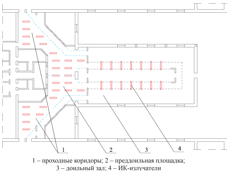
Рисунок 1. – Расстановка ИК-излучателей в доильно-молочном блоке
