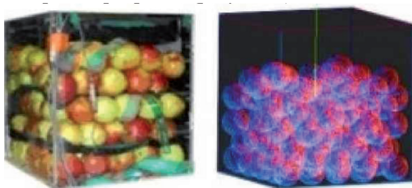
Рисунок 4. – Исследование повреждаемости яблок при транспортировке в ящике, слева – фото эксперимента, справа – модель, рассчитанная методом МДЭ
