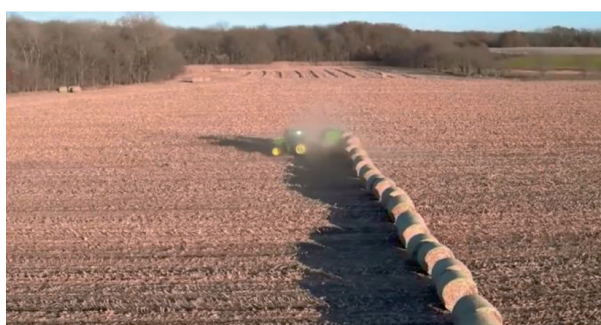
Рисунок 2. – Прессование, группирование и уборка рулонов соломы с применением накопителя рулонов фирмы John Deere (США)
