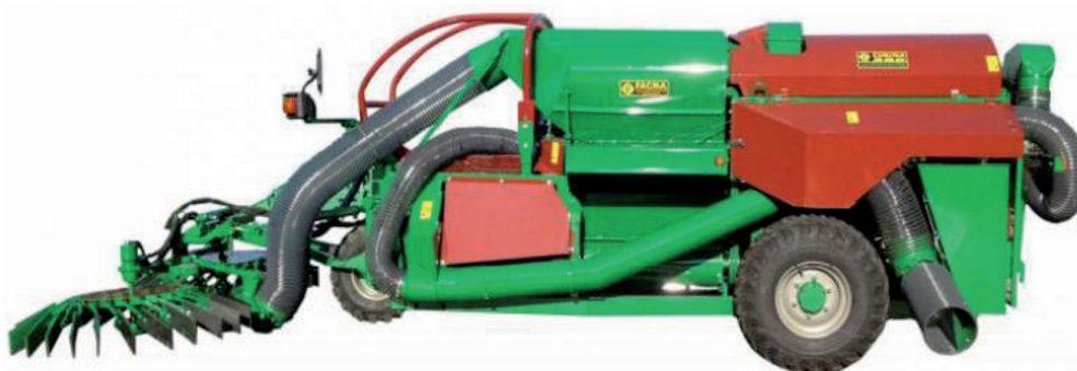
Рисунок 3. – Прицепной комбайн Cimina C380T (Италия) производительностью 2 т/ч
