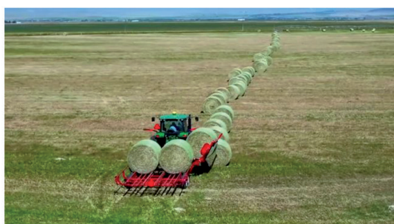
Рисунок 2. – Прессование, группирование и уборка рулонов соломы с применением накопителя рулонов фирмы John Deere (США)
