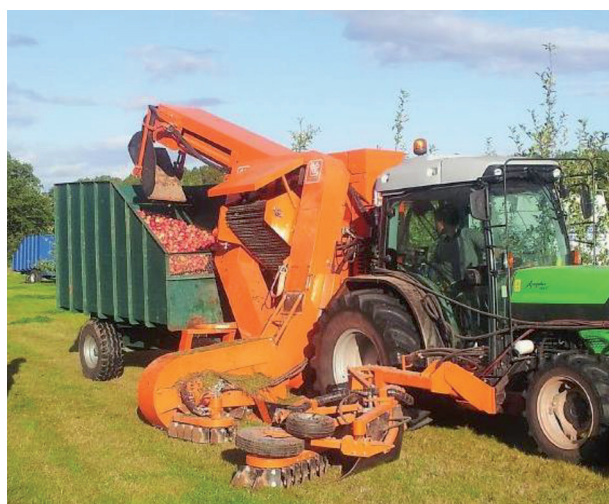
Рисунок 2. – Прицепной комбайн для уборки плодов с земли Tuthill Centipede 2015 Harvester производительностью 15 т/ч
