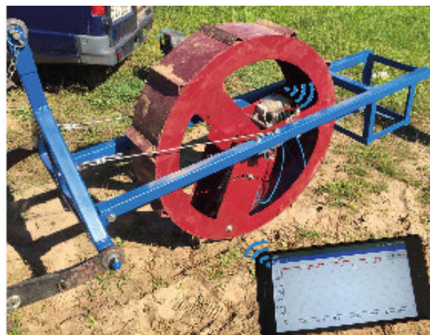
1 – рама; 2 – навесное устройство; 3 – барабан; 4 – пробоотборный зонд; 5 – кронштейн; 6 – тросовый ограничитель; 7 – беспроводной измерительный модуль; 8 – подшипниковый узел; 9 – рым-гайка Рис. 1 – Общий вид макета автоматизированного пробоотборника почвы
