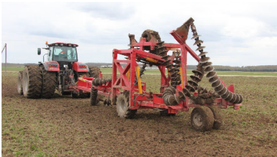
Рис. 2. – Луцильник дисковый ромбовидный ЛДР-9 в транспортном положении
