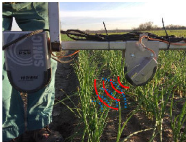
Рис. 4. – Система точного вождения Reichhardt Electronic Innovations Inc.
