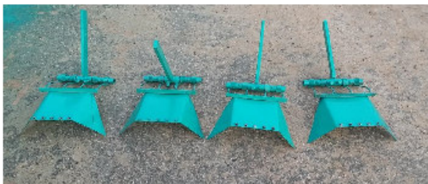
Рис. 3. – Профилеформователь узкопрофильных гряд для установки на агрегат универсальный АУ-М2 (фото комплекта)
