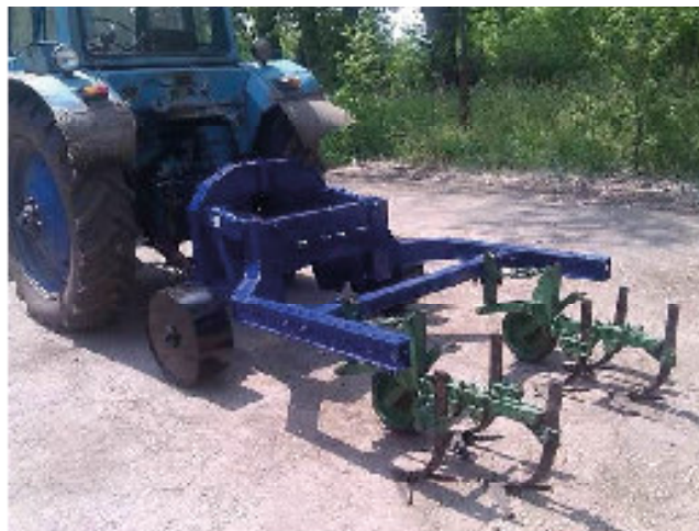
Рис. 6. – Технологический модуль для междурядной обработки маточника УКМ–МО
