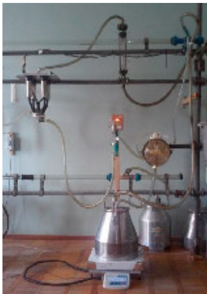
Рис. 3 – Общий вид лабораторного стенда для исследований счетчика при доении в нижний молокопровод (лабораторная имитация доильного зала)
