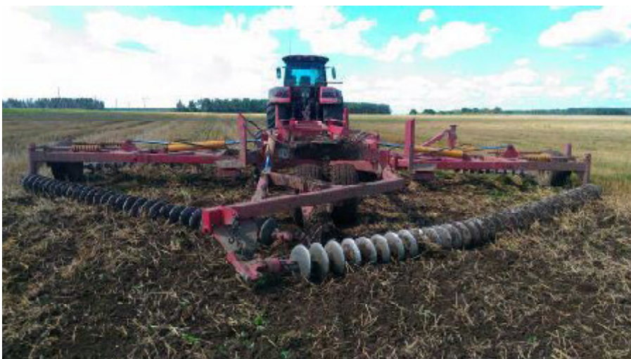
Рис. 3. – Луцильник дисковый ромбовидный ЛДР-9 в рабочем положении
