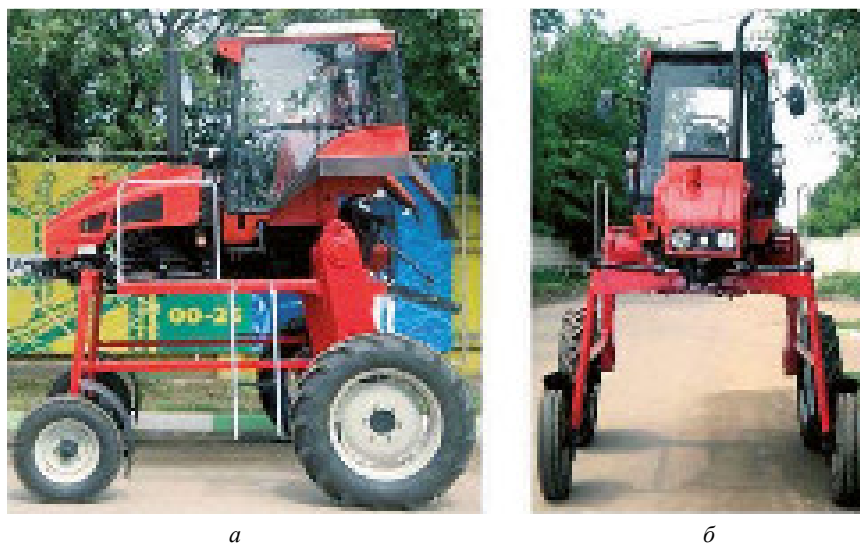
Рис. 1. – Высококлиренсное энергетическое средство ВЭС-45А
