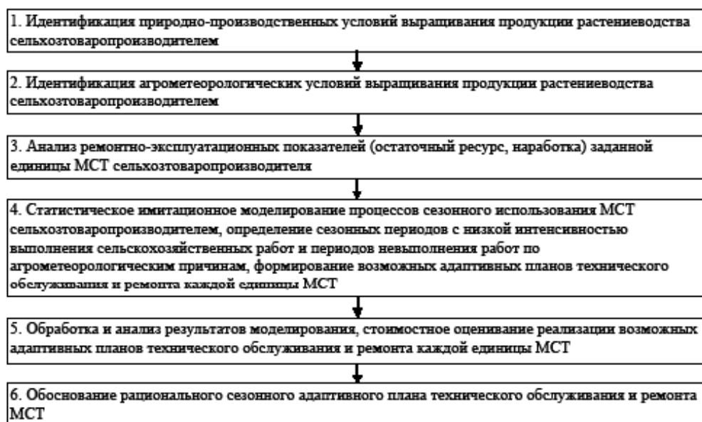
Рис. 2. – Обобщенный алгоритм обоснования рациональных сроков технического обслуживания и ремонта мобильной сельскохозяйственной техники на основе САТОР
