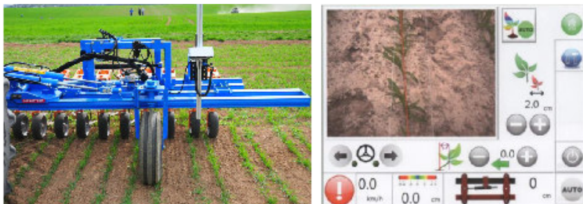
Рис. 3. – Система точного вождения фирмы Maschinenfabrik SCHMOTZER GmbH, Германия
