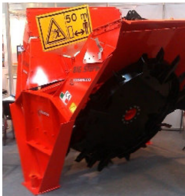
Рис. 6. – Двухфрезерный каналокопатель Cosmeco Big Storm (Италия)
