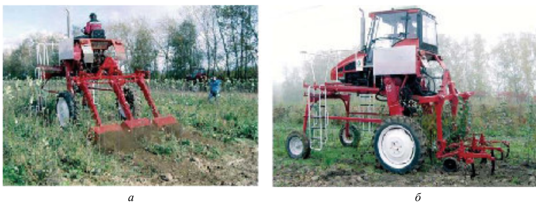
Рис. 2. – Сменные технологические модули машина ВП-4 для обработки почвы и уничтожения сорняков
