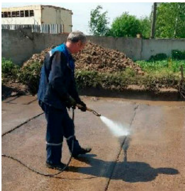
Рис. 3 – Производственные испытания опытного образца брендспойта с насадком, генерирующим кавитацию в струе ( d_n = 1,8 мм)
