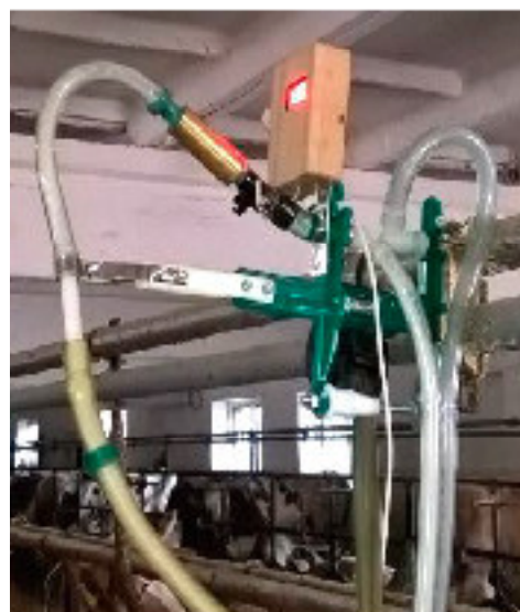
Рис. 1 – Общий вид макетного образца автоматического счетчика индивидуального надоя на базе емкостного датчика проточного типа с устройством для отбора проб
