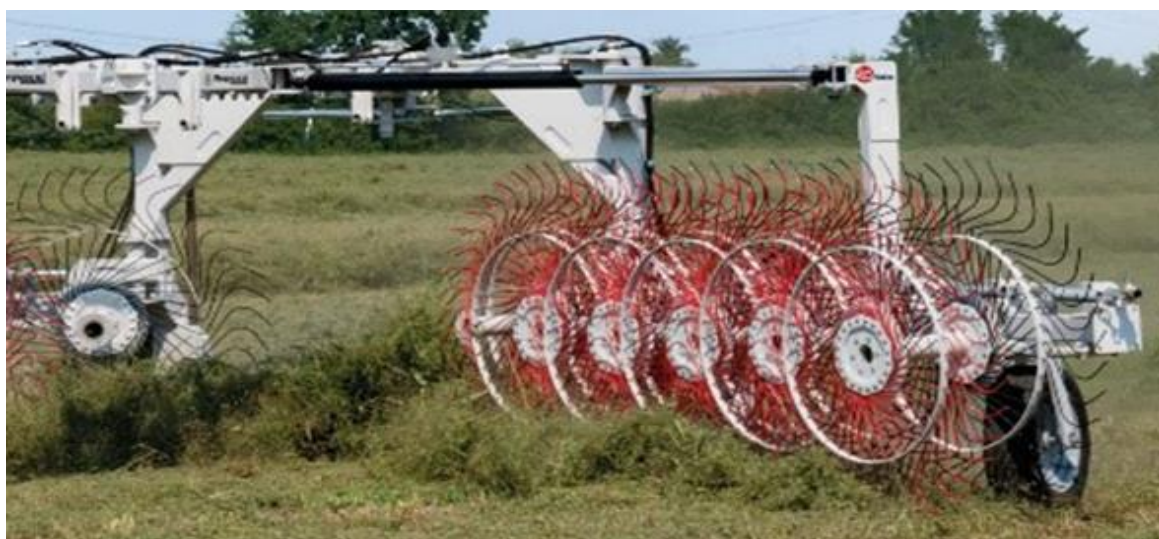
Рис. 4. Колесно-пальцевые грабли-валкователи сдвоенного типа «Ра-Рэйк 12+12» фирмы ООО «Биоком Технологии» (Республика Беларусь)
