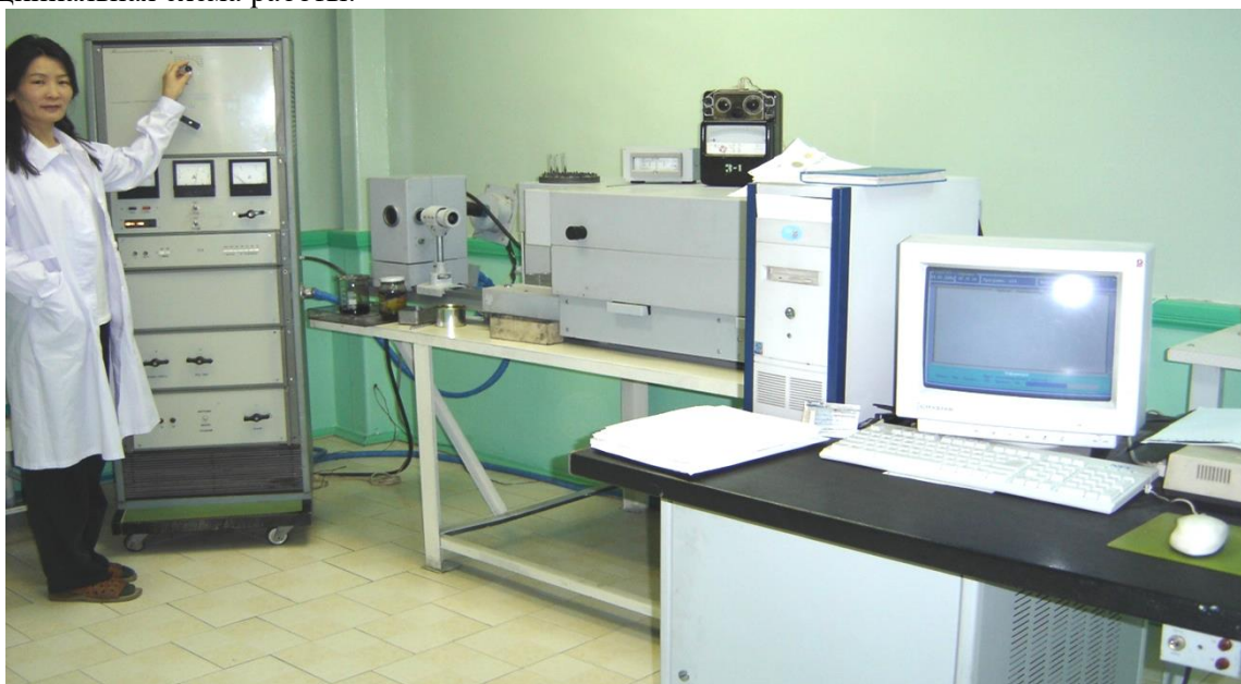
Рис. 1. Установка МФС-7М: слева у оператора источник дуги ИВС-29, правее камера для прожигки масел, в центре – квантометр со вспомогательными приборами, справа - контроллер КМТ-1 и компьютер с программным обеспечением
