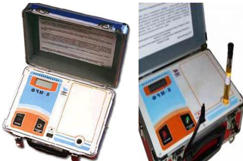
Рис. 4. Прибор ФЧМ-П контроля содержания ферромагнитных частиц в маслах
