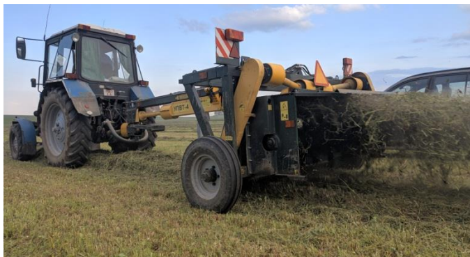
Рис. 8. Опытный образец устройства для повторного плющения и вспушивания скошенных трав УПВТ-4,0
