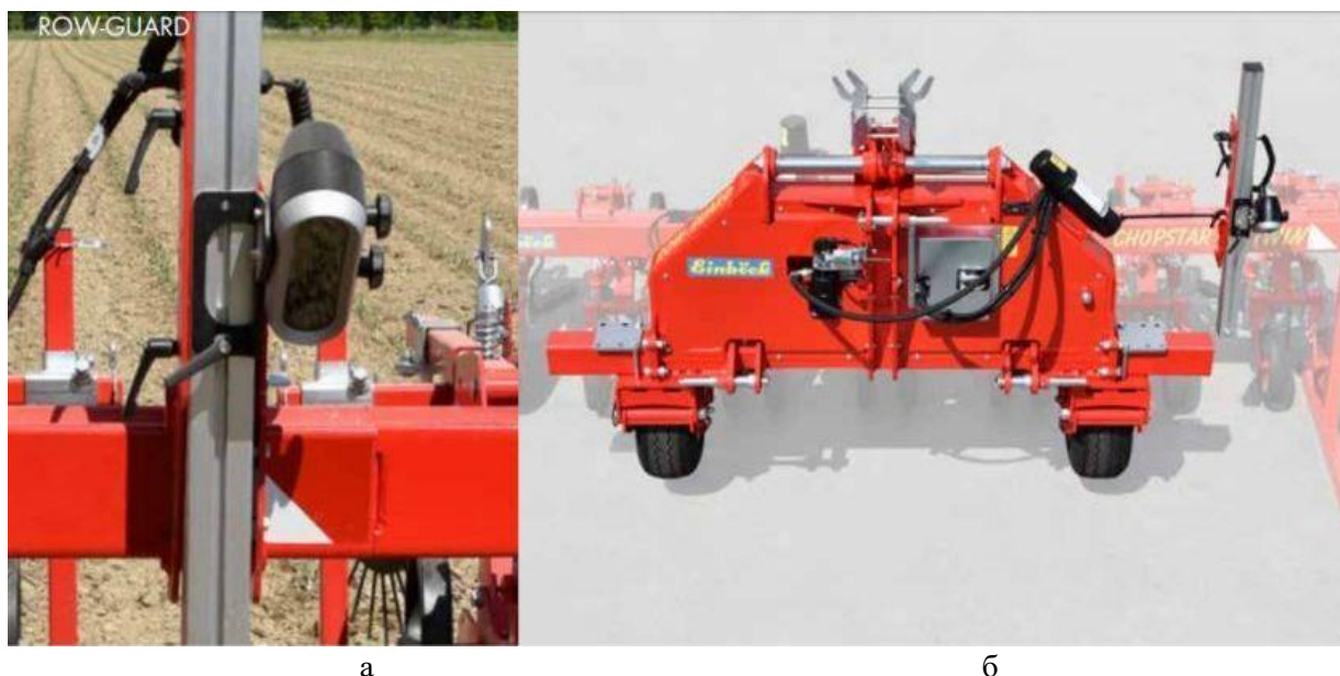
Рис. 5 – Основные элементы Camera steering system ROW-GUARD фирмы Einbock GmbH & Co [20] а - видеокамера с двумя объективами высокой четкости с разной экспозицией для улучшения работы при изменении условий света; б - система смещения культиватора относительно строки растений
