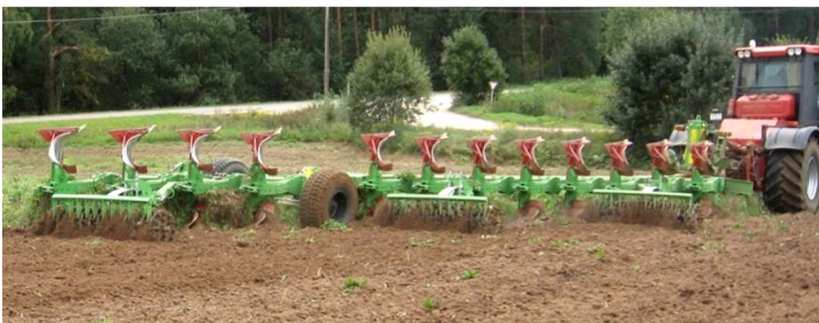
Рис. 2. 12-ти корпусный оборотный плуг ПО-(8+4)/40
