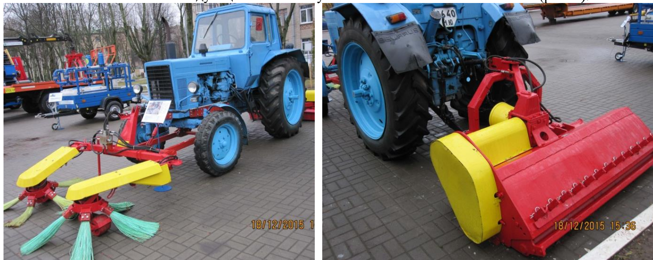
Рис. 1. Комплекс уборки веток плодовых деревьев КУВ-1,8 а – валкователь веток; б – измельчитель веток
