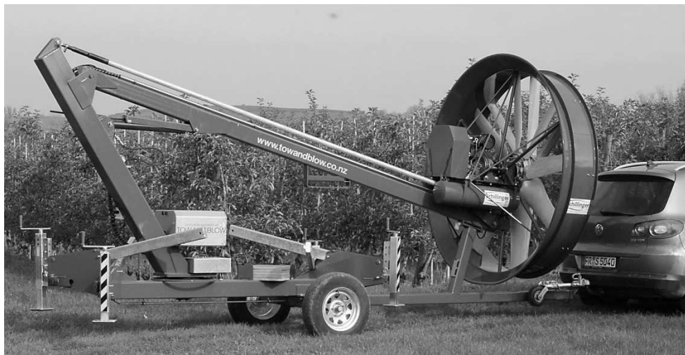
Рис. 2. Установка для перемешивания воздуха в саду (фирма Tow and Blow, Финляндия)
