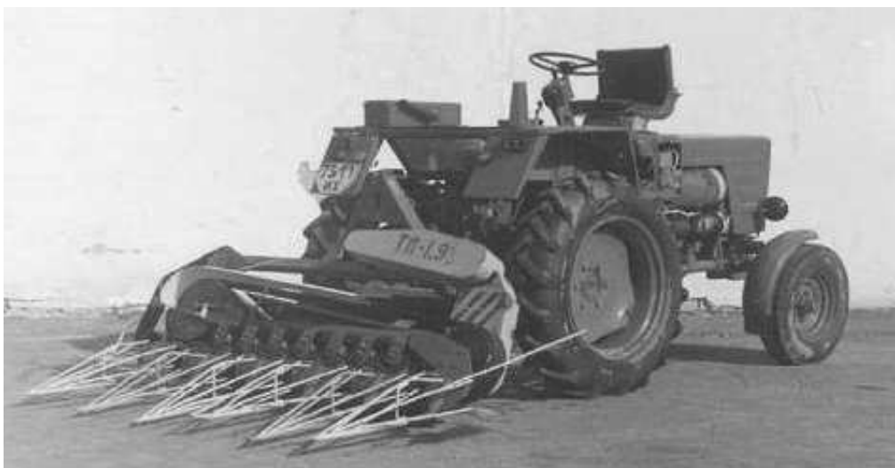
Рис. 1. Общий вид одноярусных трехгранных делителей с верхним расположением компенсаторов, установленных на теребельном аппарате льнотеребилки ТЛ-1,9
