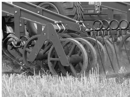
Рис. 2. Кольчатый каток с U-образным профилем кольца
