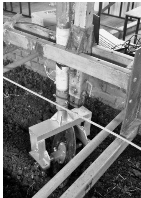
Рис. 6. Экспериментальная установка для тензометрирования дисковых рабочих органов в лабораторных условиях [6]
