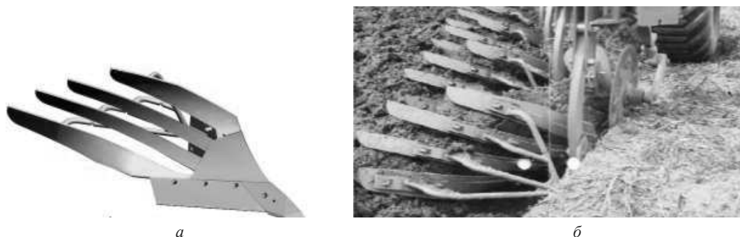
Рис. 3. Корпус Dura Maxx Hybrid: а – общий вид; б – процесс работы
