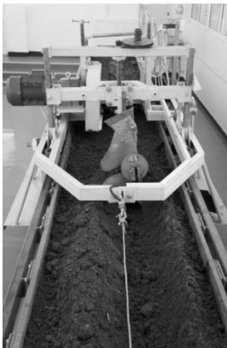
Рис. 7. Установка для измерения тягового сопротивления рабочих органов ( a – опорного колеса) и элементов ( б – корпуса плуга) почвообрабатывающих машин [7]
