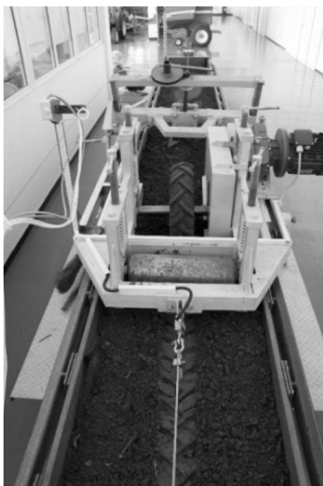
Рис. 7. Установка для измерения тягового сопротивления рабочих органов ( a – опорного колеса) и элементов ( б – корпуса плуга) почвообрабатывающих машин [7]
