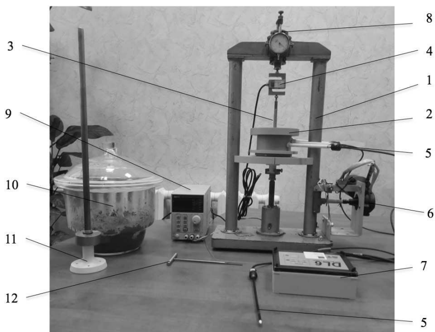
Рис. 1. Внешний вид прибора для определения адгезионных характеристик почвы: 1 – рама; 2 – чаша; 3 – шток с уплотняющим диском; 4 – тензодатчик; 5 – тензиометры; 6 – электродвигатель привода чаши; 7 – многоканальный регистратор данных; 8 – индикатор перемещений часового типа; 9 – блок питания; 10 – эксикатор; 11 – молоток Проктера; 12 – почвенный бур
