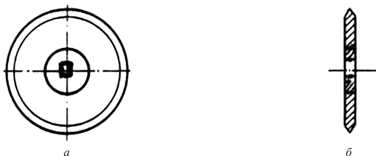
Рис. 1. Плоский диск: а – вид сбоку; б – разрез диска
