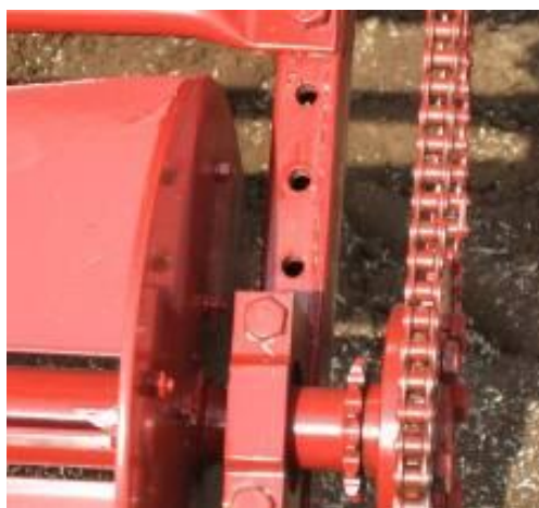
Рисунок 14 – Конструкция крепления ротора к рамке
