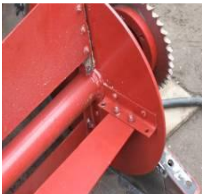
Рисунок 16 – Конструкция крепления скошенных лопастей
