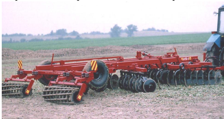
Рисунок 40 – Агрегат комбинированный для минимальной обработки почвы АКМ-4
