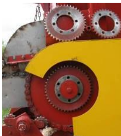
Рисунок 15 – Набор сменных звездочек для варьирования частоты вращения ротора
