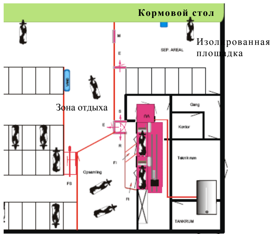
Рисунок 94 – Фрагмент коровника и доильно-молочного блока. Доильный робот «Дубль-бокс» Westfalia (Германия)
