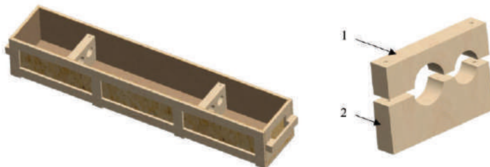
Рис. 5. 3D вид упора и прижима, расположенных в ящике: 1 – прижим; 2 – упор
