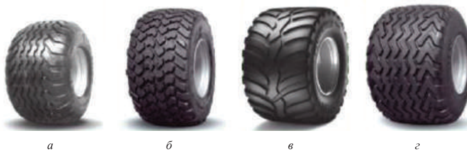
Рис. 1. Шины зарубежных большегрузных тракторных прицепов: а – диагональная шина 710/45–22.5 TL; б – радиальная шина 710/50R26.5TL; в – радиальная шина 750/45R26.5TL; г – радиальная шина 800/45R26.5TL
