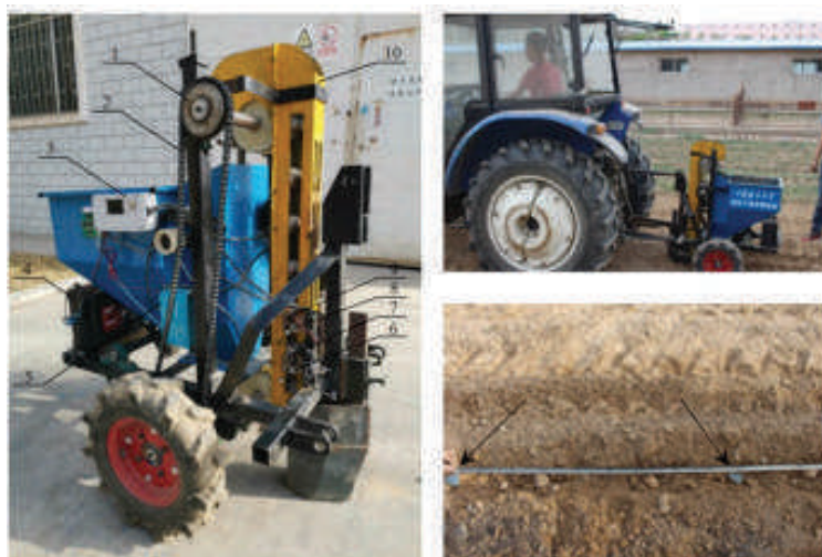
Рис. 1. Экспериментальная установка: 1 – обгонная муфта; 2 – цепь; 3 – системный контроллер; 4 – привод; 5 – датчики положения ложечки; 6, 7 – комплект фотоэлектрических датчиков для определения дозировки клубней; 8 – дозатор клубней
