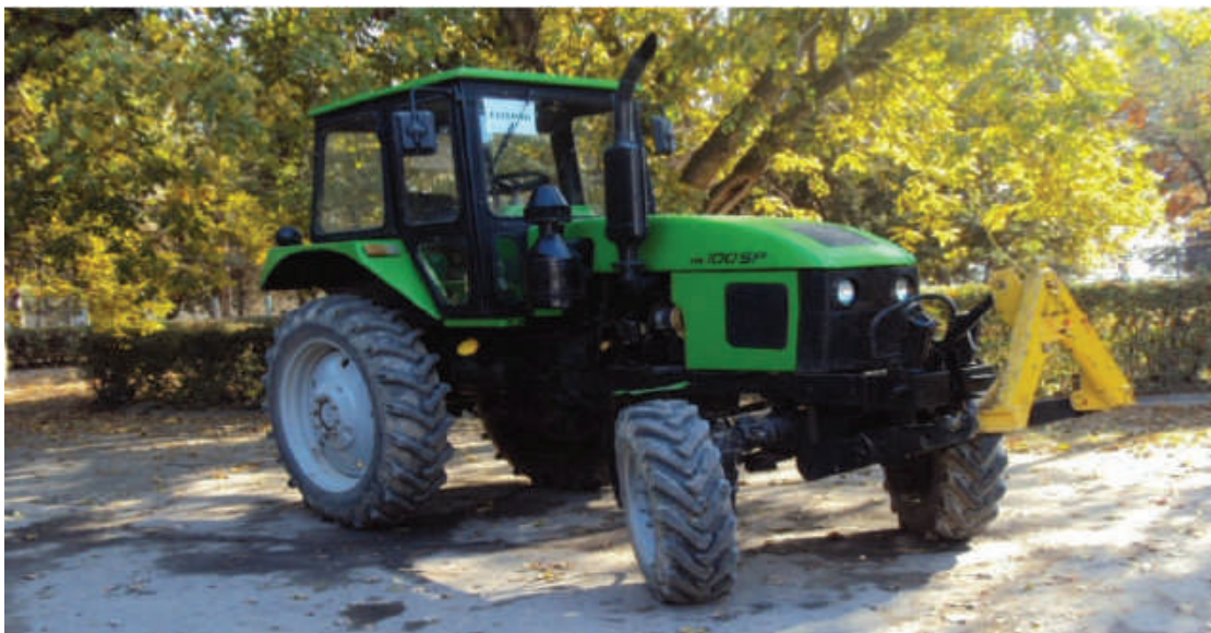
Рис. 1. Овощеводческий трактор ТТЗ-100SP
