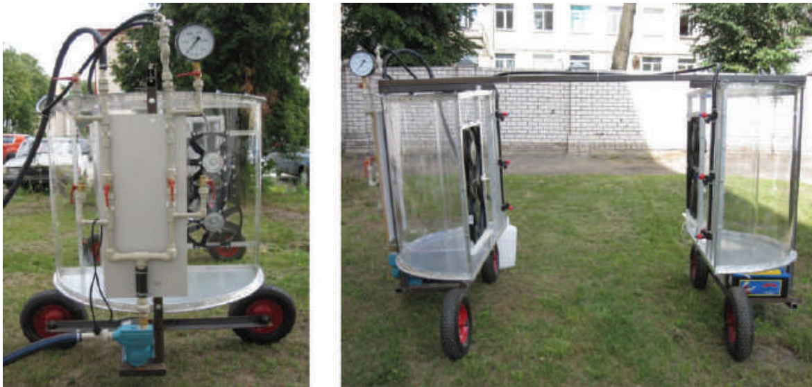
Рис. 1. Туннельное устройство шатрового опрыскивателя
