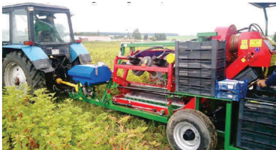
Рис. 11. Прицепной ягодоуборочный комбайн КПЯ
