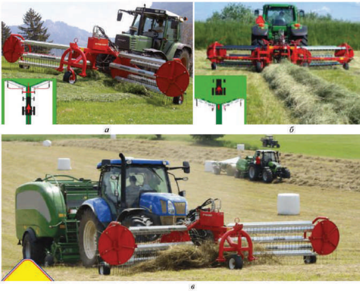
Рис. 3. Гребенчатые грабли-валкователи mod. 7500FP фирмы «Reposi Macchine Agricole S.R.L.»: а – расположение граблей-валкователей спереди (фронтальное); б – расположение граблей-валкователей сзади; в – в комбинации с пресс-подборщиком
