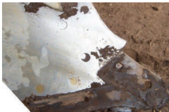
Рис. 2. Корпус плуга с утраченными долотом и лемехом из-за разрушения шляпок крепежных болтов. Выработка 21 Га. Песчаные почвы
