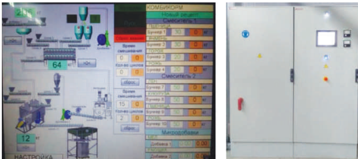
Рис. 3. Общий вид панели управления АСУ ТП комплекта комбикормового оборудования
