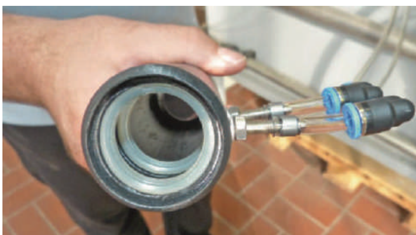
Рис. 1. Доильный стакан с надувными кольцами
