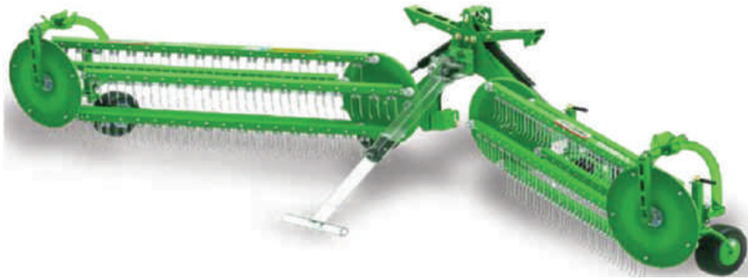
Рис. 5. Грабли-валкователи гребенчатого типа TWIST 600 фирмы «SaMASZ»
