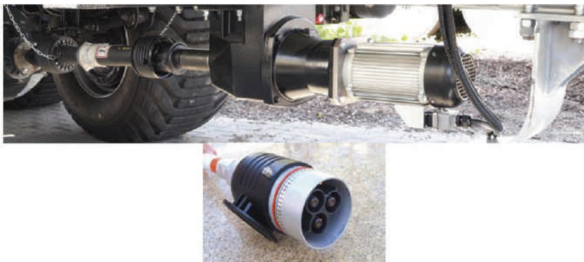
Рис. 5. Приводная ось «Power Drive Elect» фирмы Fliegl
