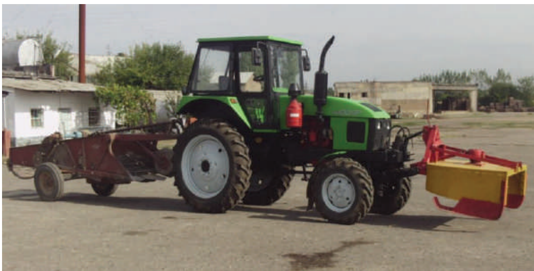
Рис. 5. Комбинированный агрегат, навешиваемый на овощеводческий трактор ТТ3-100SP, состоящий из ботвоизмельчителя и картофелекопателя
