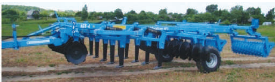
Рис. 2. Агрегат для безотвальной обработки почвы АБТ-4
