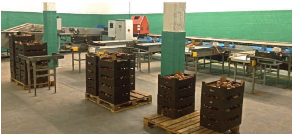
Рис. 14. Технологическая линия сортировки и фасовки яблок ЛСП-4
