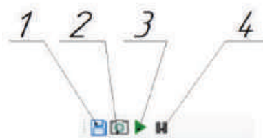
Рис. 4. Панель инструментов: 1 – сохранение настроек положения ROI; 2 – включить камеру; 3 – запуск камеры с паузы; 4 – постановка камеры на паузу
