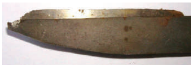
Рис. 2. Макрошлиф наплавленного плужного долота (производство Минского завода шестерен)
