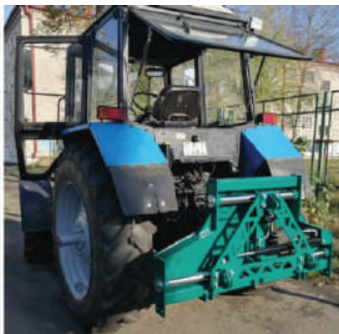
Рис.9. Автоматическая управляемая навесная система
