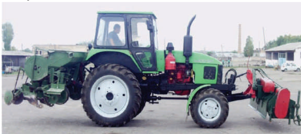
Рис. 3. Комбинированный агрегат, навешиваемый на овощеводческий трактор ТТЗ-100SP, состоящий из почвенной фрезы и картофелесажалки
