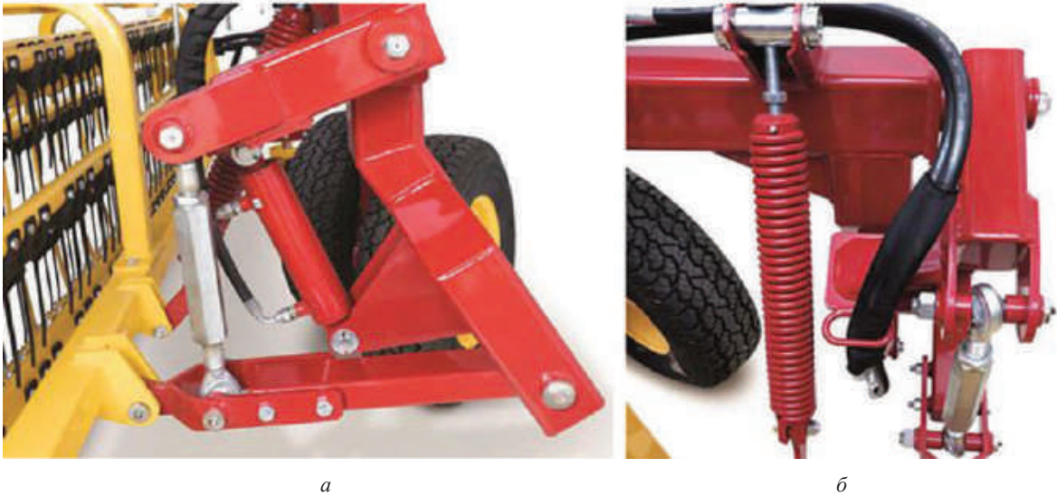
Рис. 2. Система регулируемых пружин гребенчатых рабочих органов Rolabar rakes 230: а – вид слева; б – вид спереди
