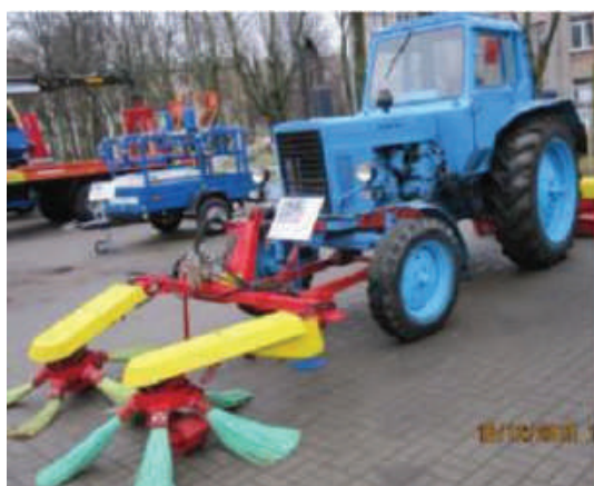
Рис. 13. Комплекс уборки веток плодовых деревьев КУВ-1,8: а – валкователь веток; б – измельчитель веток.
