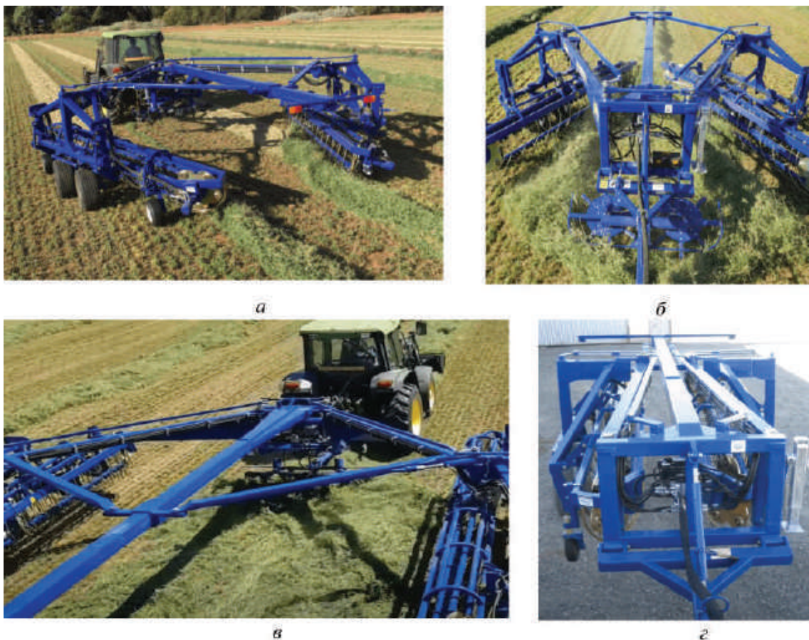
Рис. 8. Грабли-валкователи гребенчатого типа BR1200С фирмы «Berrima Engineering»: а – оборачивание валков со смещением, б – ворошение валка с одновременным формированием его обратно в валок, в – ворошение валка, г – в транспортном положении
