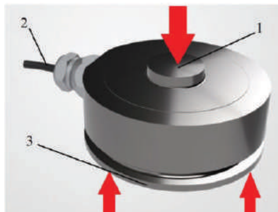
Рис. 7. Датчик нагрузки (наращения давления в компоненте) LOAD CELL: 1 – точка приложения силы (соединения с компонентом); 2 – информационный кабель; 3 – опорная площадка
