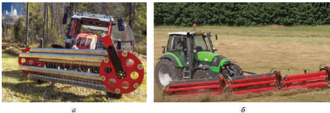
Рис. 7. Модульная система граблей-валкователей Clementer 550 F: а – одна секция рабочих органов, б – три секции рабочих органов
