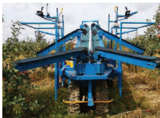
Рис. 12. Агрегат самоходный универсальный для сбора плодов и обрезки деревьев АСУ-6
