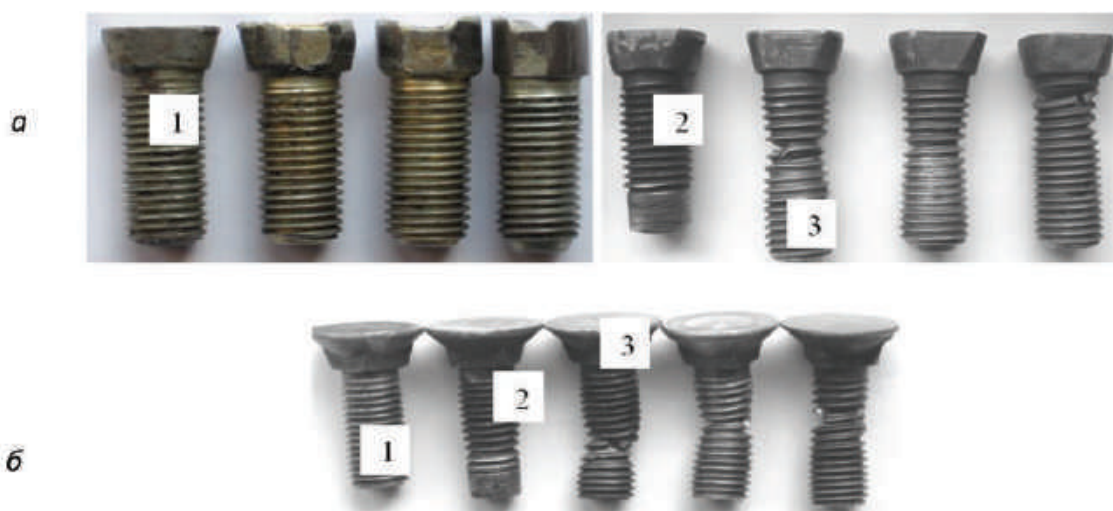
Рис. 7. Вид разрушения крепежных элементов: а – 1 – болт стандартный из стали 40X; 2 – ЭХТО + термообработка (ТО); 3 – закалка + низкий отпуск (Н.О.); б – 1 – болты стандартные из стали 20; 2 – ЭХТО + ТО; 3 – закалка + Н.О.
