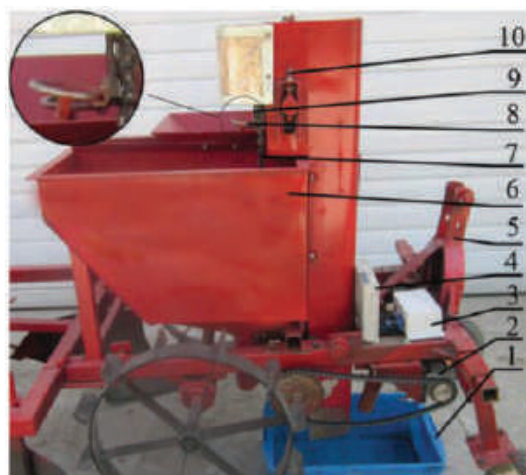
Рис. 4. Экспериментальная установка картофелесажалки цепочно-чашечного типа: 1 – ящик для забора клубней; 2 – мотор-редуктор; 3 – контроллер; 4 – привод; 5 – рама; 6 – бункер; 7 – цепь; 8 – высаживающий стакан; 9 – защитная пластина; 10 – натяжное устройство
