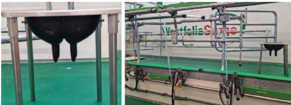
Рис. 3. Доильная установка Westfalia Surge с установкой «искусственное вымя»
