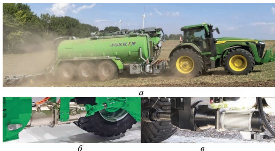
Рис. 4. Сельскохозяйственные прицепы и цистерны с активными осями с электроприводом: а – полевые испытания трактора John Deere 8R 410 с цистерной Joskin, оборудованной двумя задними осями с электроприводом, на внесении жидких органических удобрений; б – привод осей прицепов и цистерн фирмы Joskin; в – привод осей прицепов «Power Drive Elect» фирмы Fliegl (Германия)
