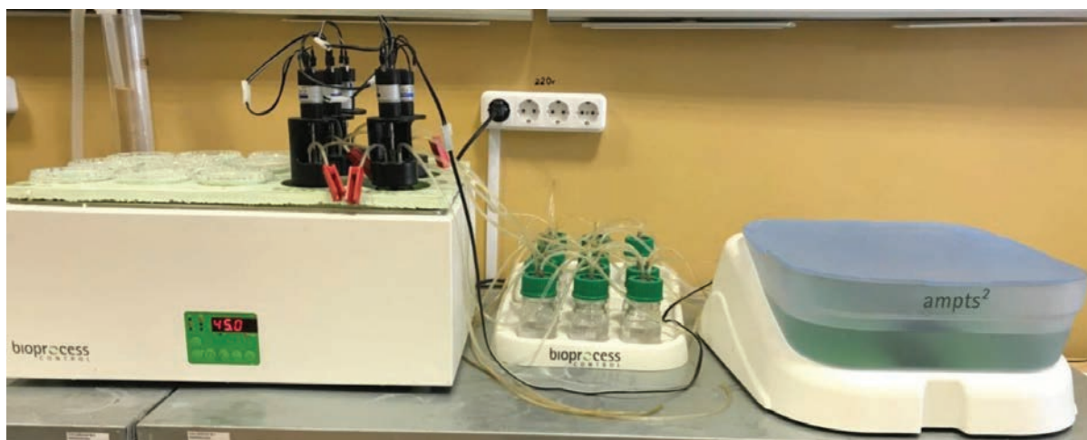
Рис. 3. Автоматизированный комплекс по определению выхода метана в процессе анаэробной биоферментации органического сырья
