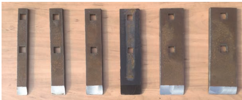
Рис. 1. Сменные долотья для рыхлительного рабочего органа шириной 0,03; 0,04; 0,05; 0,06; 0,07; 0,08 м (слева направо)
