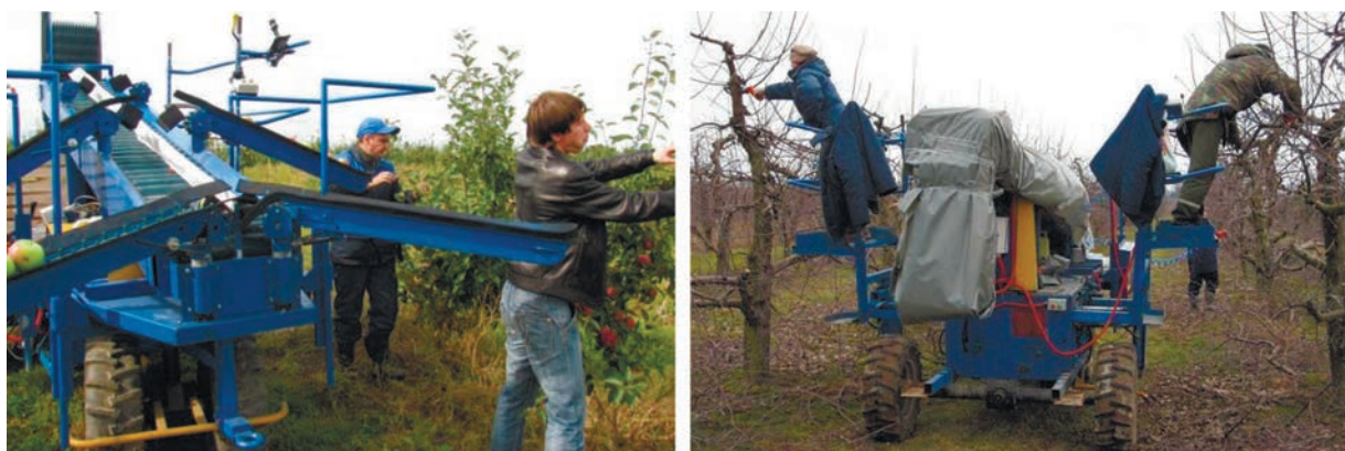
а б Рис. 4. Агрегат АСУ-6 на уборке яблок (а) и обрезке деревьев (б)
