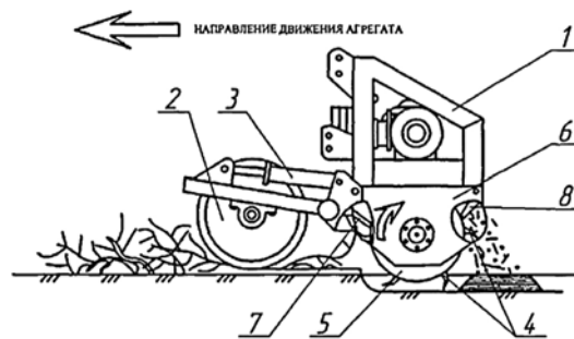
Рис. 1. Схема машины для измельчения и заделки щепы в почву [10]: 1 – рама; 2 – трамбовочный барабан; 3 – сервопривод; 4 – ножи; 5 – барабан; 6 – кожух; 7 и 8 – передние и задние контрножи
