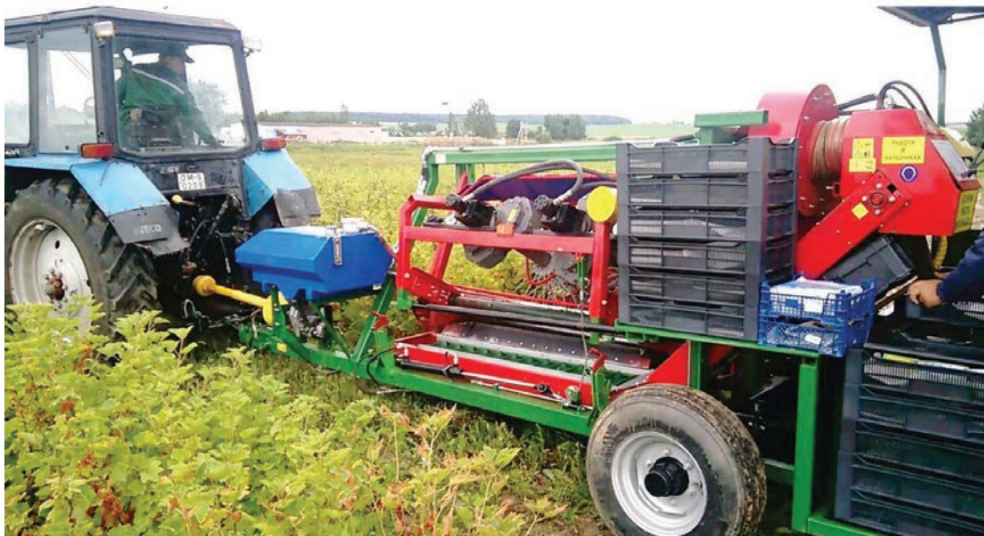
Рис. 7. Уборка смородины ягодоуборочным комбайном КПЯ
