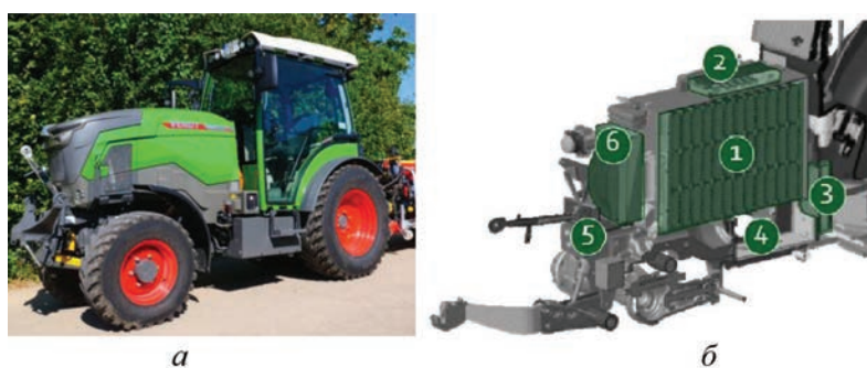
Рис. 5. Аккумуляторный электротрактор Fendt e107 V Vario: а – внешний вид; б – компоновка силового блока и управляющей электроники: 1 – высоковольтная Li-Ion аккумуляторная батарея (700 В, 100 кВт·ч); 2 – блок управления быстрой зарядкой постоянным током и стандартной зарядкой переменным током при напряжении 400 В (стандарт CCS Combo 2); 3 – эффективный электродвигатель с высокой удельной мощностью; 4 – блок управления питанием; 5 – передний ВОМ; 6 – система управления температурным режимом
