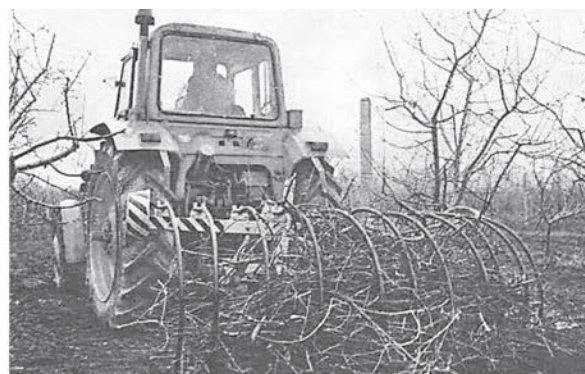
Рис. 3. Машина для сбора срезанных ветвей СВ-1
