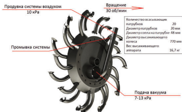
Рисунок 1 – Высаживающий аппарат пневматического типа с обоснованными конструктивными и режимными параметрами
