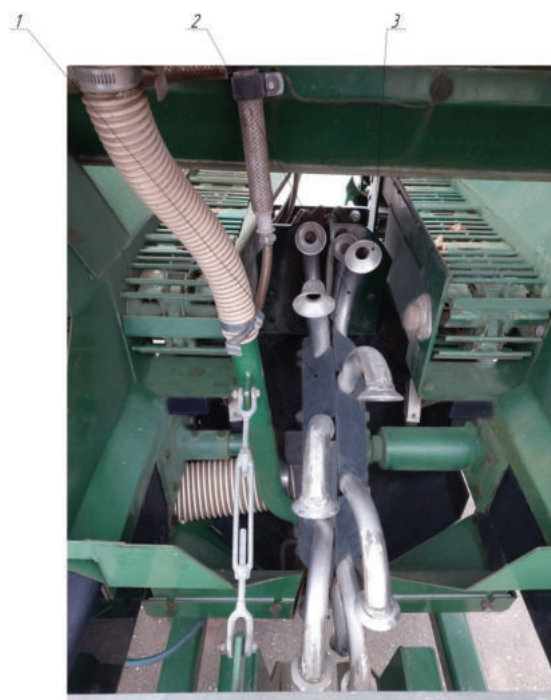
Рисунок 4 – Высаживающий аппарат пневматического типа (общий вид): 1 – высаживающее колесо; 2 – всасывающий рукав; 3 – всасывающее сопло
