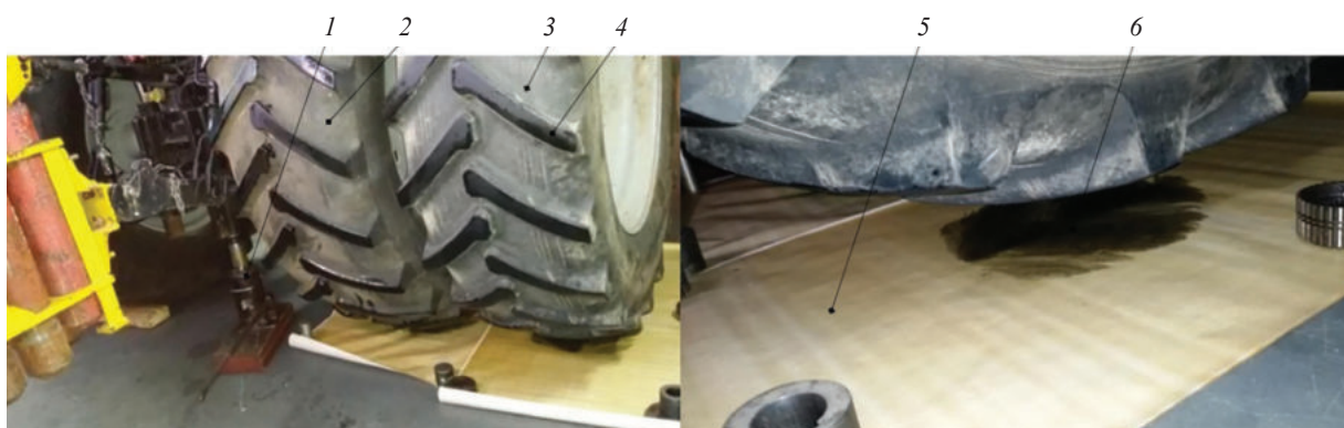
Рисунок 2 – Определение контурной площади пятна контакта шин трактора «Беларус-2022.5» на жестком основании: 1 – домкрат; 2 – основное внутреннее колесо; 3 – дополнительное наружное колесо; 4 – красящее вещество на грунтозацепах протектора; 5 – миллиметровая бумага; 6 – отпечаток пятна контакта
