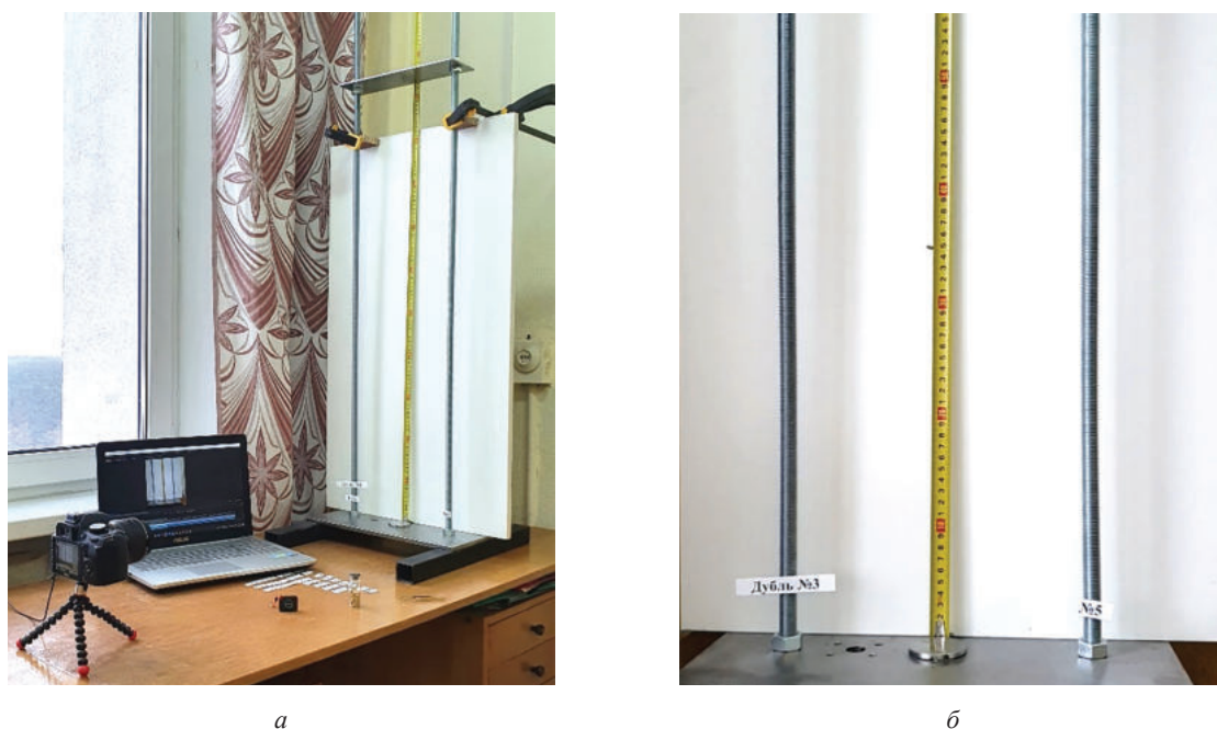
Рисунок 4 – Лабораторная установка для исследования коэффициента восстановления зерна: a – общий вид лабораторной установки; б – изображение, получаемое фотофиксацией
