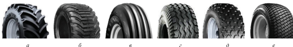
Рисунок 1 – Основные виды протекторов сельскохозяйственных шин: а – с грунтозацепами «елочка»; б – с грунтозацепами «клюшка»; в – с продольными ребрами; г – с продольными волнами; д – «блочный» («шашечный») ромбообразный; е – «блочный» S-образный (зигзагообразный)
