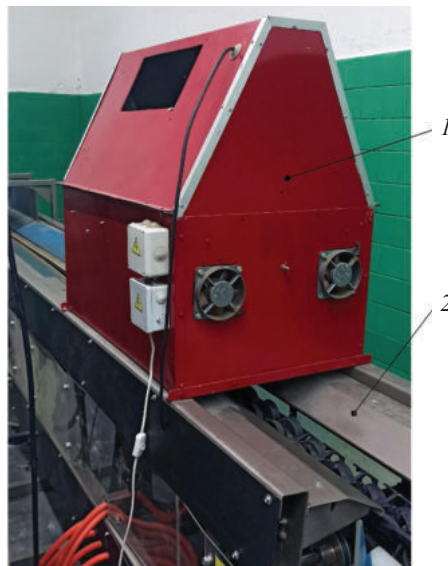
Рисунок 4 – Фотомодуль системы технического зрения, установленный на главном конвейере: 1 – фотомодуль СТЗ; 2 – главный конвейер
