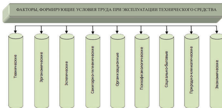
Рисунок 1 – Классификация факторов, формирующих условия труда при эксплуатации технического средства
