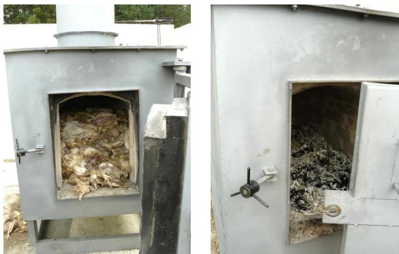
Рисунок 51 – Загрузка инсинератора и зольные остатки после сжигания
