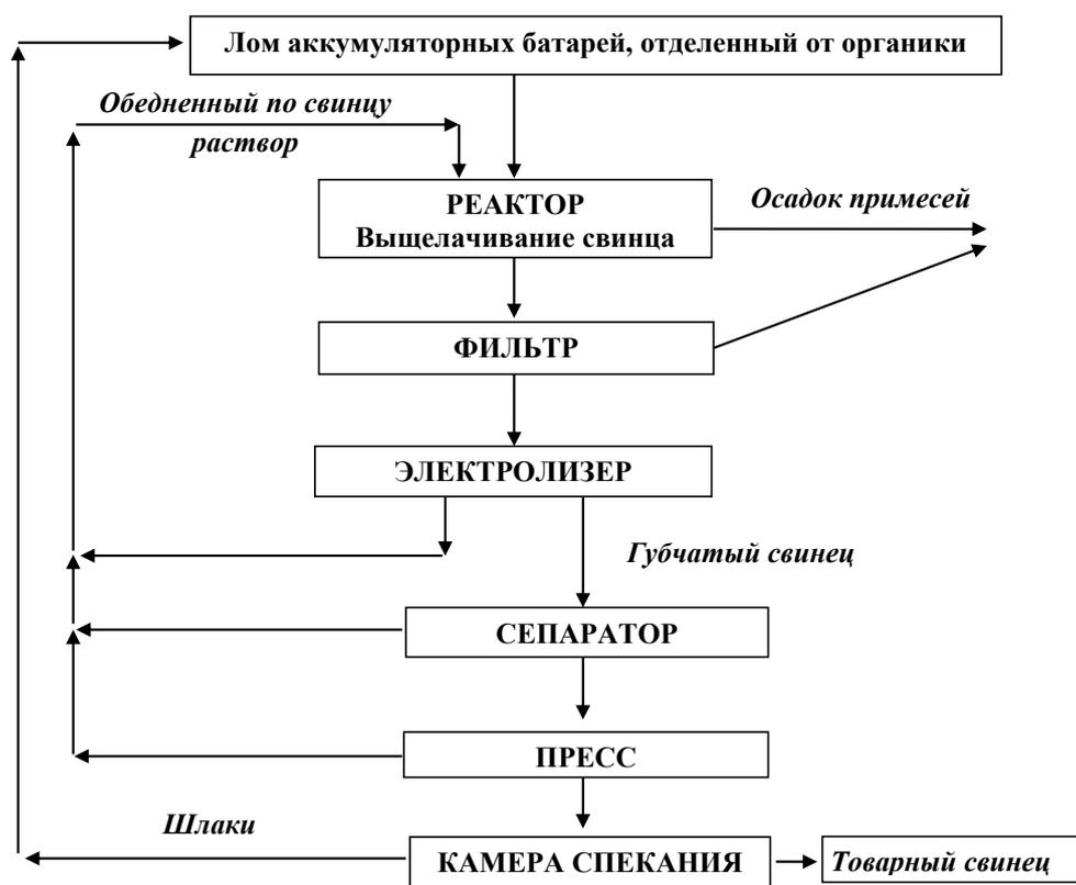
**Рисунок 43 – Технологическая схема переработки свинецсодержащего сырья**
