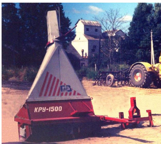
Рисунок 15 – Экспериментальный образец косилки-измельчителя КРУ–1500
