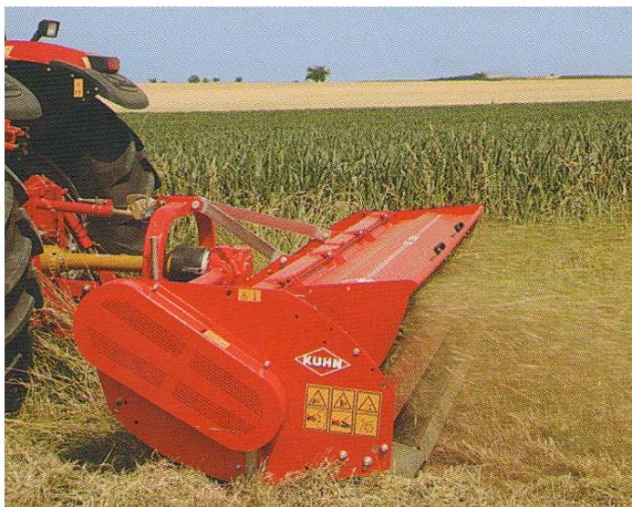
**Рисунок 13 – Измельчитель пожнивных остатков ВК320 фирмы «Кюн» (ширина захвата 3,2 м)**
