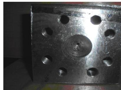
**Рисунок 68 – Дроссель с конoidalным отверстием**
