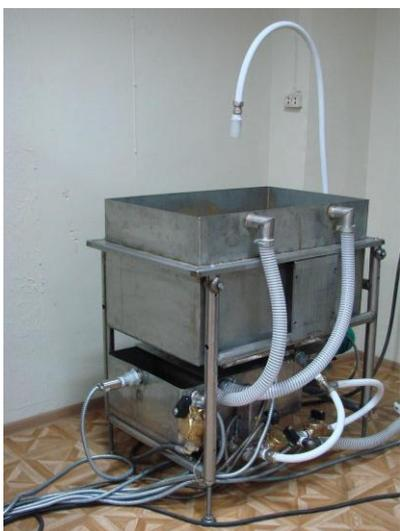
**Рисунок 34 – Общий вид устройства ультразвуковой очистки доильных аппаратов УУД–40**
