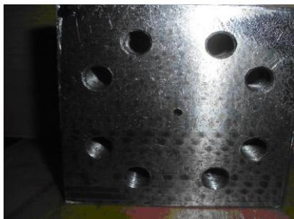
**Рисунок 66 – Дроссель с отверстием в толстой стенке**
