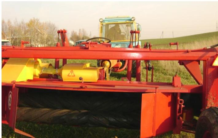
**Рисунок 12 – Косилка-плющилка прицепная с плющильными шевронными обрезиненными вальцами**
