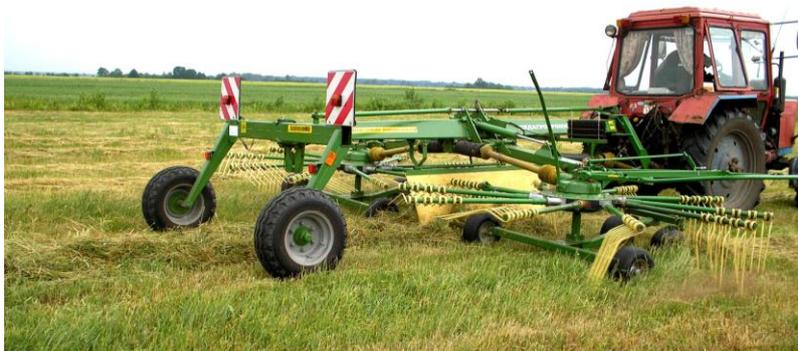
**Рисунок 5 – Грабли-валкователь ГВЦ-6,6 в рабочем положении**
