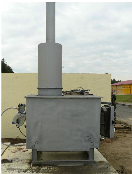
Рисунок 50 – Общий вид экспериментального образца инсинератора
