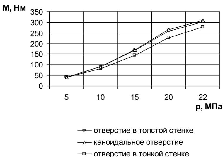
**Рисунок 69 – Зависимости тормозного момента на валу насоса от давления в нагнетательной магистрали**
