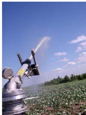
**Рисунок 62 – Установка дождевальная УД-2500 на полове капусты**
