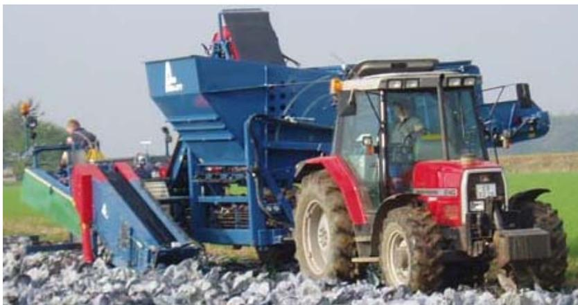
**Рисунок 83 – Полунавесной капустоуборочный комбайн ТК-140В**
