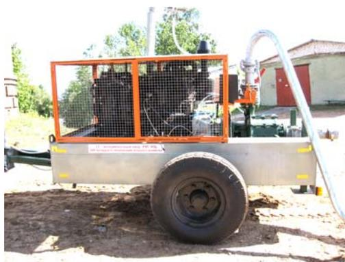
**Рисунок 63 – Станция дизельнасосная СДН-100/80**
