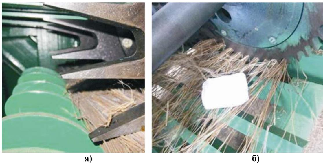
Рисунок 101 – Заполнение впадин дисков слоеформирующей машины: а) первого; б) последнего
