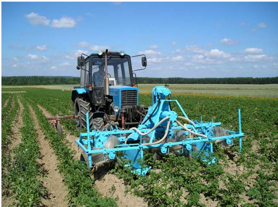
**Рисунок 78 – Комбинированный агрегат для сбора колорадского жука и окучивания картофеля в работе**
