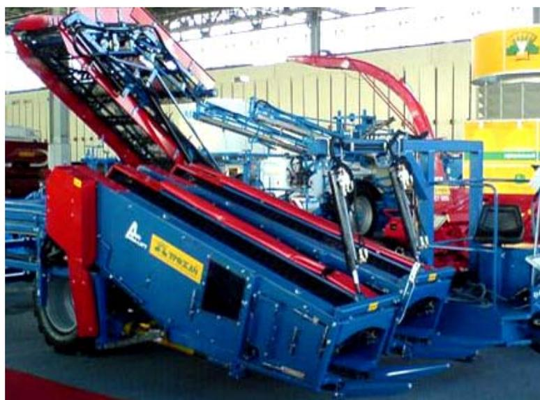
**Рисунок 84 – Полунавесной капустоуборочный комбайн ТК-2000**
