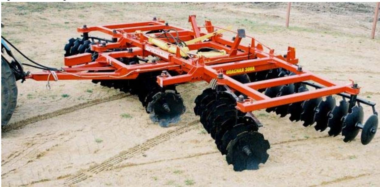
**Рисунок 23 – Тяжелый прицепной дисковый луцильник БПТБ-7**
