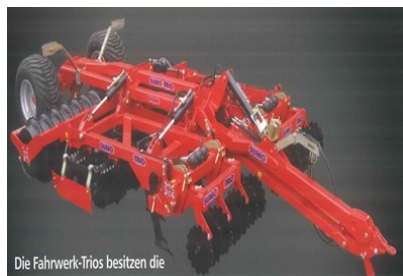
Рисунок 21 – Дискалоповая борона фирмы «Sumo» (Великобритания)
