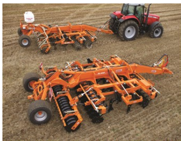
Рисунок 20 – Дискалоповая борона фирмы «Simba» (Великобритания)
