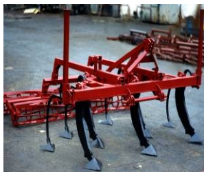
Рисунок 25 – Техника для глубокого рыхления
