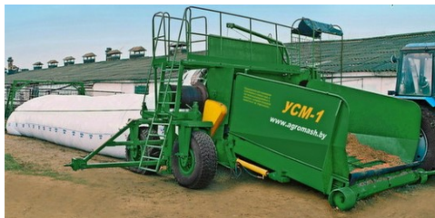
Рисунок 122 – Упаковщик УСМ-1 в работе
