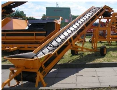
Рисунок 91 – Транспортер загрузочный ТВН-40
