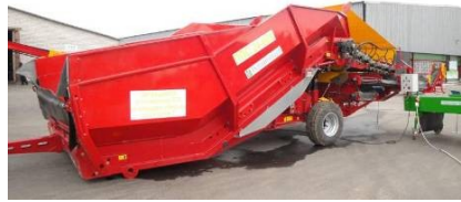
Рисунок 85 – Пункт приемно-сортировочный ППС 24-60
