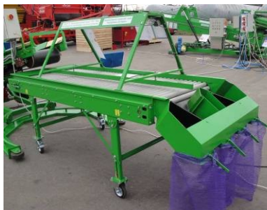
Рисунок 90 – Переборочный стол СПР-10
