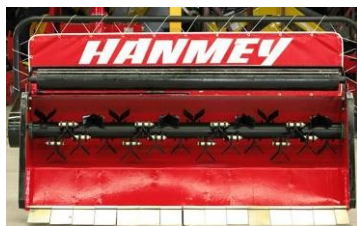
Рисунок 63 – Общий вид рабочего органа с Y-образными ножами косилки-измельчителя EFG 125 «Hanmey» (Китай)
