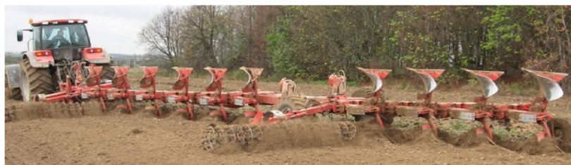
Рисунок 41 – Плуг полунавесной оборотный ПО-(6+4)-40/45 в агрегате с трактором «Беларус-3522» на вспашке поля со стерней зерновых культур
