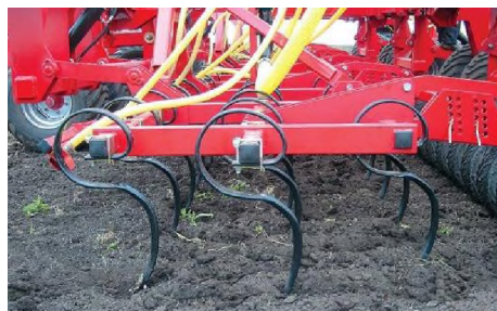
Рисунок 47 – Лаповые рабочие органы с устройством для внесения минеральных удобрений
