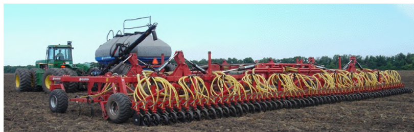
Рисунок 44 – Почвообрабатывающе-посевной агрегат «Terminator» фирмы «Hatzenbichler» с установленными на универсальной раме секциями культиваторных почвообрабатывающих рабочих органов
