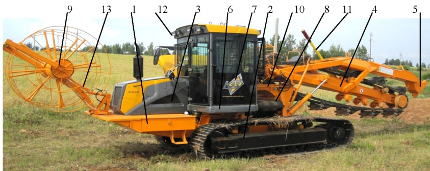
Рисунок 111 – Общий вид экскаватора-дреноукладчика с лазерным уклономером ЭТЦ-203
