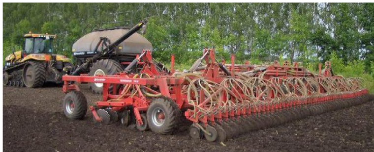
Рисунок 45 – Почвообрабатывающе-посевной агрегат «Terminator» фирмы «Hatzenbichler» с установленными на универсальной раме секциями дисковых почвообрабатывающих рабочих органов
